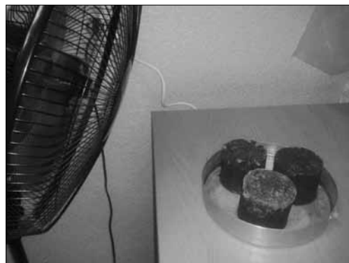
Рис. 2. Ускоренное испытание прессованных цементных образцов на высолообразование
