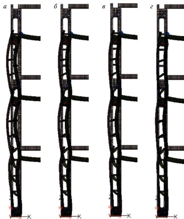
Рис. 5. Перемещения наружных трехслойных стеновых панелей: а – уступ отсутствует; б – уступ шириной 1 см; в – уступ шириной 2 см; г – уступ шириной 3 см; высота уступа (бороздки) во всех случаях 3 см
