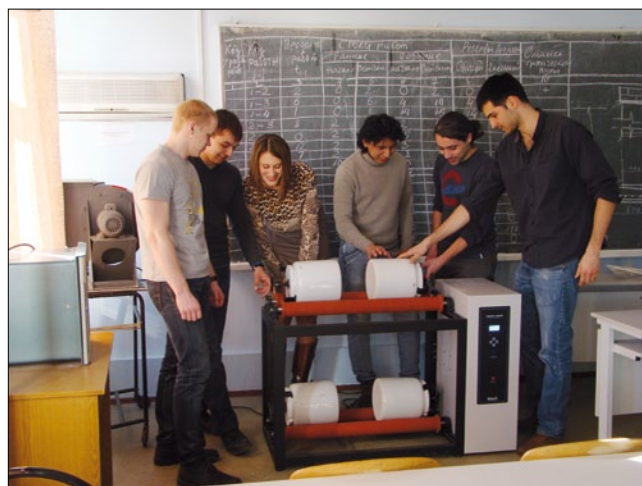
Рис. 2. Подготовка материалов в мельнице с электронным программным управлением для составления наноконпозиции
