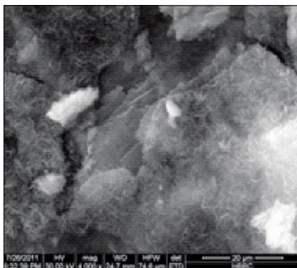
Рис. 2. Обработанный толуолом образец УНТ
