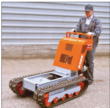
Рис. 1. Гусеничные шасси думпера
