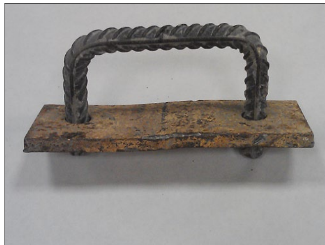
Рис. 8. Вид пластины и скобы после испытаний
