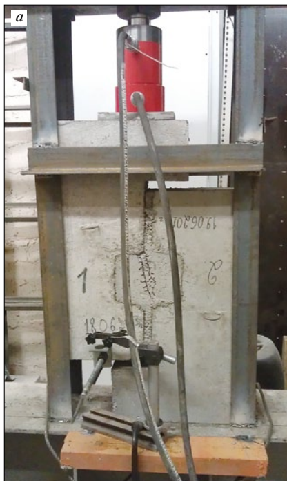
Рис. 6. Фрагмент узла для испытания на сдвиг: а — фрагмент на стадии образования в бетоне наклонной трещины; б — образец с оголенной соединительной пластиной
