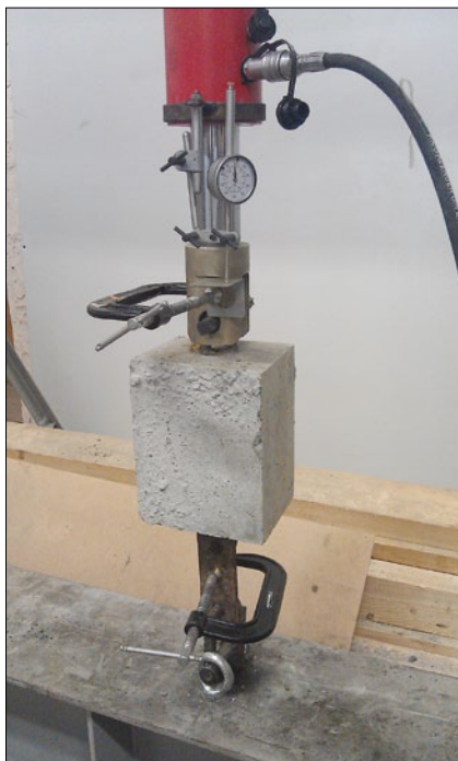
Рис. 5. Фрагмент узла для испытания на разрыв
