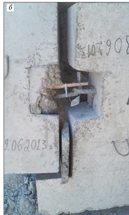
Рис. 6. Фрагмент узла для испытания на сдвиг: а — фрагмент на стадии образования в бетоне наклонной трещины; б — образец с оголенной соединительной пластиной
