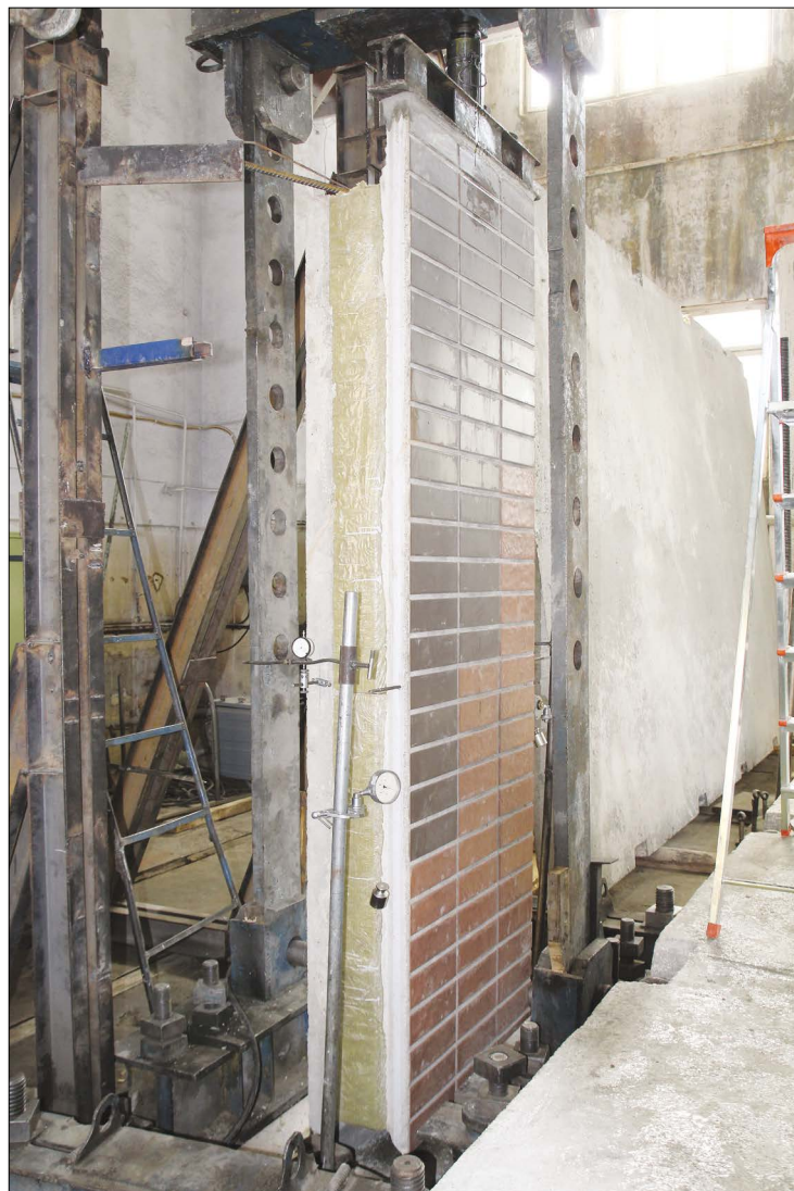
Рис. 2. Фрагмент трехслойной наружной стеновой панели с композитными диагональными гибкими связями во время испытаний на сдвиг
