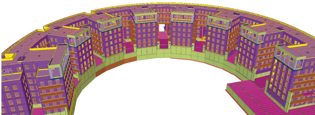
Крупнопанельный жилой дом. Швеция. Округлая форма самого здания, сложная подземная часть с огромным количеством перепадов высот. Присутствуют и двухслойные, и трехслойные, и однослойные панели. Перекрытие паркинга – пустотные плиты безопалубочного формования. Перекрытие жилых помещений – монолитные плиты по флигранам
