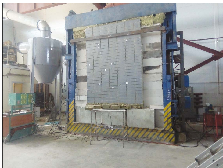
Рис. 3. Фрагмент трехслойной наружной стеновой панели с композитными диагональными гибкими связями во время испытаний на огнестойкость
