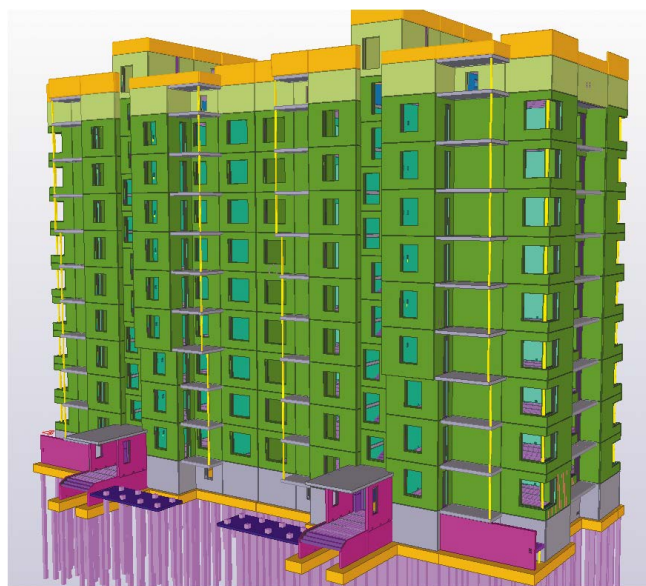
Крупнопанельный жилой дом. Россия. Применялись трехслойные и однослойные панели. Перекрытия – пустотные плиты безопалубочного формования
