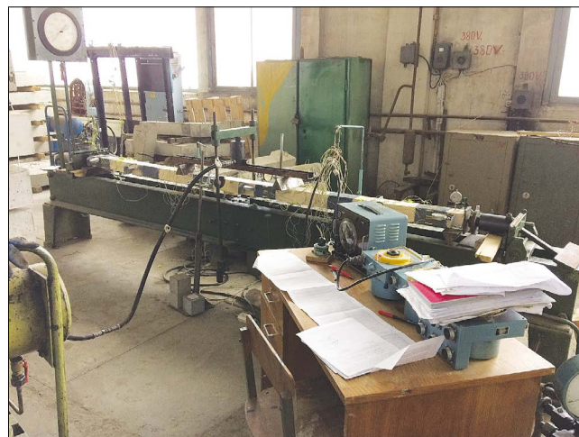
Рис. 4. Деревянный сжато-изогнутый элемент в процессе испытаний
