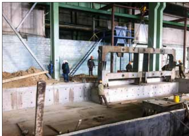
Рис. 8. Перенос кассетной установки СМЖ
