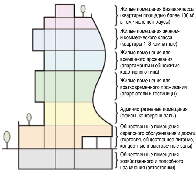
Рис. 6. Схема возможного размещения помещений различного назначения в многофункциональном здании
