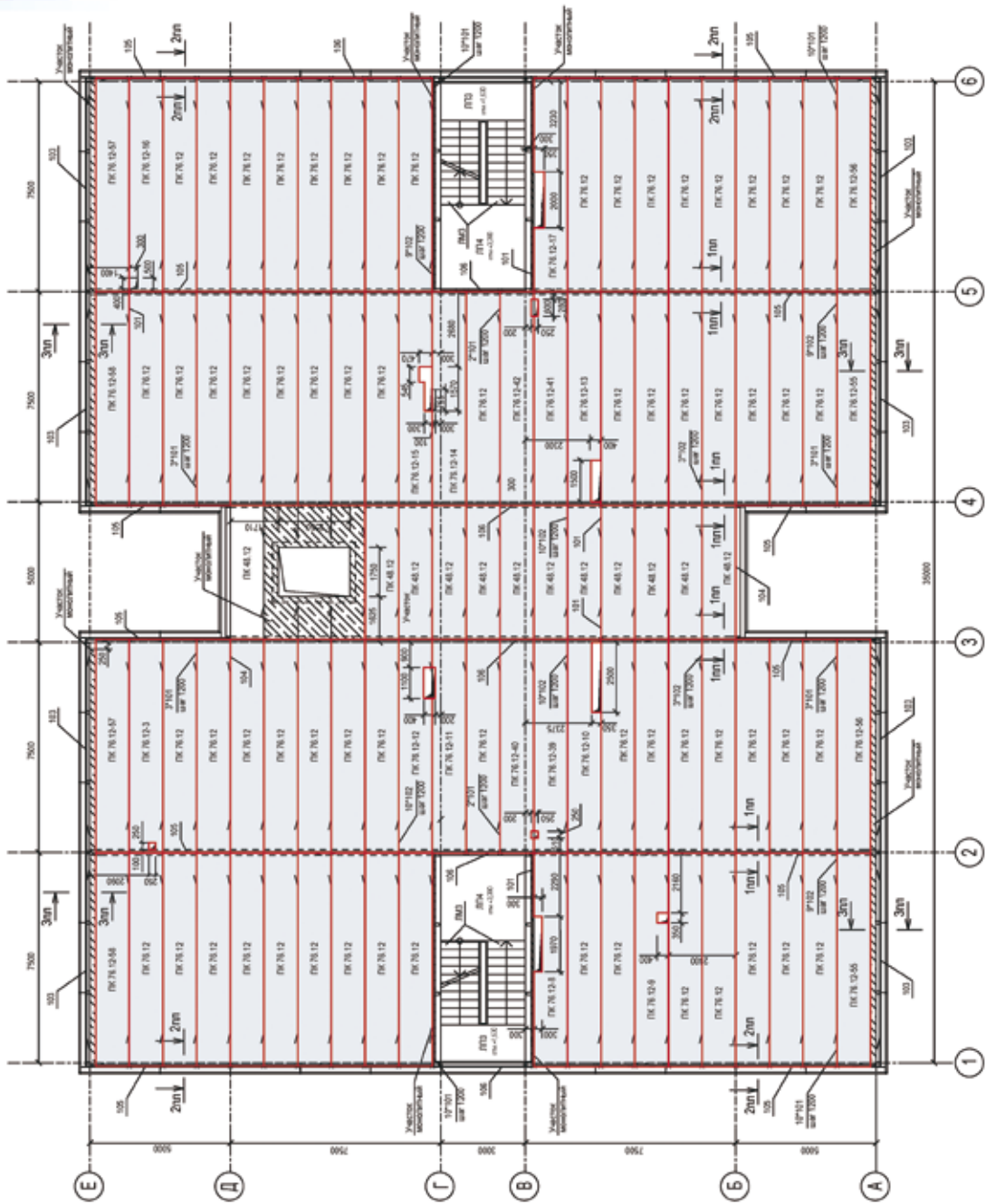
РАСКЛАДКА ПЛИТ ПЕРЕКРЫТИЯ
