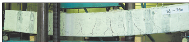
Рис. 3. Характер трещинообразования балки с 2Ø7 АБК
