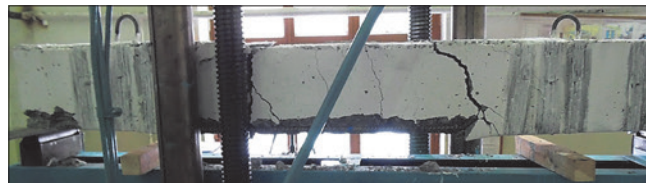
Рис. 4. Разрушенная балка с 2Ø8 АСК от проскальзывания арматуры стеклокомпозитная арматура (АСК) с 250 МПа до 400 МПа момент трещинообразования увеличивается на 26,77%. У образцов с 2Ø8 мм АСК на 13,68%.
