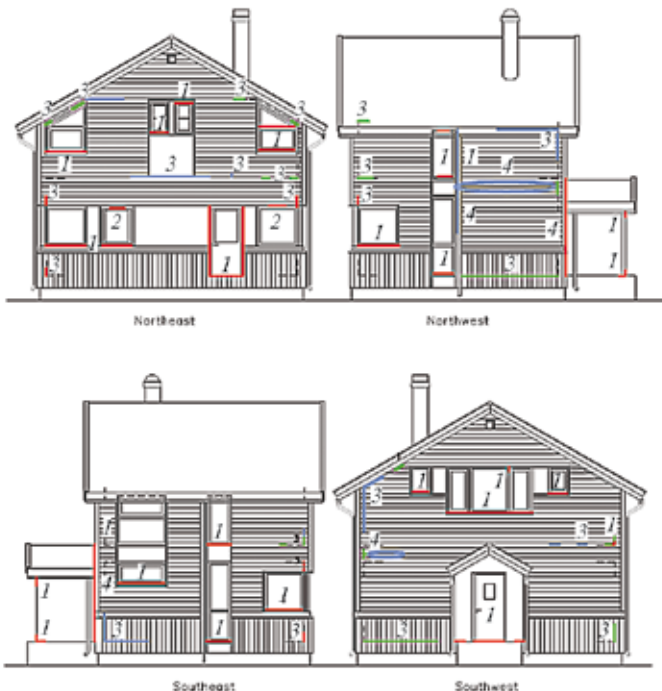
Рис. 7. Схема дефектов в ограждающих конструкциях экспериментального здания, зафиксированных при инфракрасной дефектоскопии: — <math>< 6^{\circ}\text{C}</math>; — 6–12°C; — >12°C. Классификация дефектов: 1 – неэффективная герметизация оконных и дверных проемов является легкоустраняемым дефектом; 2 – наличие элементов вентиляции в окнах в виде клапанов является не дефектом, а самым простым конструктивным решением регулирования естественной вентиляции; 3 – теплопотери в узлах сопряжения панелей (рис. 5); 4 – теплопотери в узлах сопряжения модулей (рис. 4, б) – дефект монтажа здания из модулей на стройплощадке
