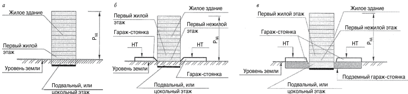
Рис. 1. Основные схемы размещения на земельном участке жилого здания, плоскостной стоянки автомобилей и гаража-стоянки: а – плоскостная стоянка автомобилей, размещаемая в уровне земли; б – пристроенный к жилому зданию гараж-стоянка под надземной территорией (НТ); в) пристроенный к жилому зданию гараж-стоянка под надземной территорией (НТ) и в подземном пространстве
