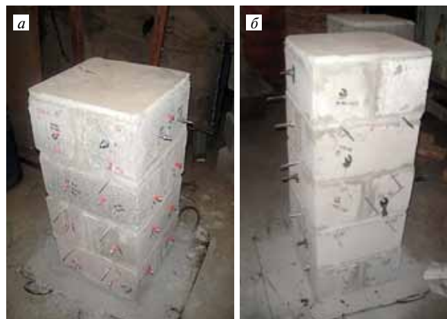
Рис. 1. Экспериментальные образцы-столбы сечением 410х400 мм на основе стеновых блоков из легкого бетона на гранулированном пеностекле марки «Неопорм»: а – из блоков плотностью D600, прочностью В2; б – из блоков плотностью D800, прочностью В5
