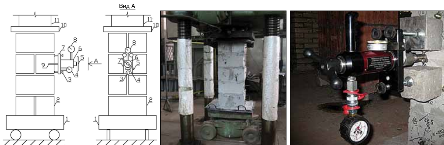
Рис. 2. Схема проведения испытаний несущей способности анкерных креплений в кладке на основе блоков из легкого бетона на стекло-видных заполнителях: 1 – передвижная опора; 2 – образец кладки; 3 – опоры прибора; 4 – индикатор часового типа; 5 – рукоятка для подачи нагрузки; 6 – гидравлический цилиндр (прибор HYDRAJAWS); 7 – опорная площадка прибора; 8 – манометр; 9 – анкерный элемент или гибкая связь; 10 – распределительная пластина; 11 – гидравлический пресс.
