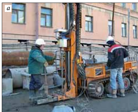
Рис. 5. Инструментальное определение измененных свойств грунтов методом статического зондирования с использованием установки RIG 204 D (а) и пример осредненного графика q_c и f_c для площадки №2 (б)
