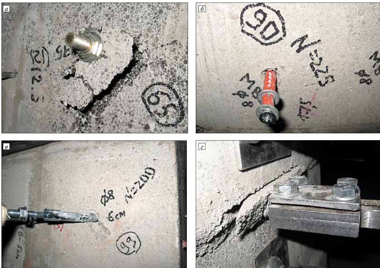
Рис. 3. Испытание крепежных систем, установленных в кладку блоков из легкого бетона на стекловидных заполнителях: а – химические анкеры Mungo; б – распорные полиамидные дюбели Mungo; в – распорные металлические анкеры Mungo; г – гибкие связи из базальто-пластиковой арматуры
