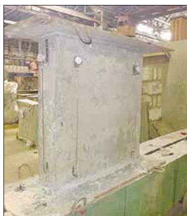
Рис. 8. Испытание образцов конструкции простенков с применением опалубки Proster®21
