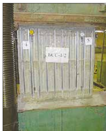
Рис. 8. Испытание образцов конструкции простенков с применением опалубки Proster®21
