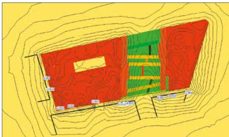
Рис. 9. Изолинии осадок примыкающей территории, м Fig. 9. Sediment isolines of the adjacent territory, m
