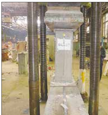
Рис. 7. Испытание образцов колонн
