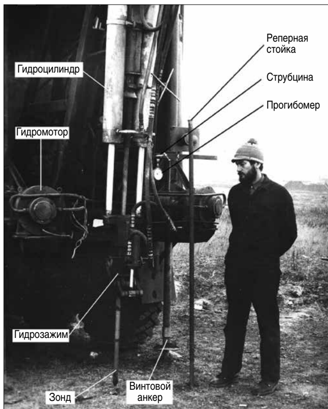
Рис. 3. Статическое зондирование многолетнемерзлых грунтов на инженерном поле Северного Отделения НИИОСП в г. Воркуте с дополнительным измерением осадки зонда в процессе стабилизации Fig. 3. Cone penetration testing of permafrost soils on the engineering field of the Northern Branch of the NIIOSP in Vorkuta with additional measurement of the probe precipitation during stabilization
