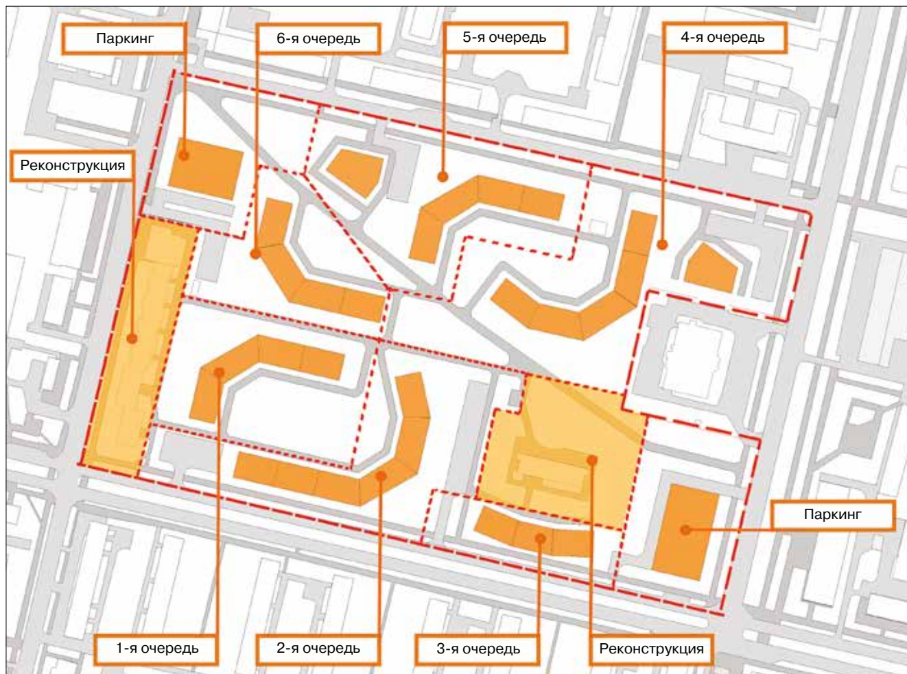
Рис. 7. Очереди строительства 205-го микрорайона и порядок волнового переселения Fig. 7. The construction phase of the 205th microdistrict and the order of wave relocation
