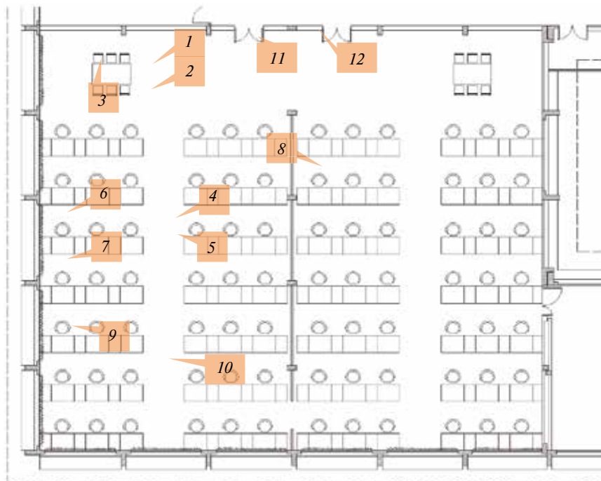
Рис. 15. Схематический план залов рисования 1-го и 2-го курса с общим стратегическим подходом к использованию наноматериалов: 1 – стол: анти-отпечатки пальцев; 2 – окно: самоочищающееся фотокаталитическое, окно: самоочищающееся фотохроматическое или электрохромное; 3 – стены: наночастицы керамического покрытия; 4 – стулья: грязеотталкивающие; 5 – рисунок поверхности стола: защита от отпечатков пальцев, защита от царапин; 6 – шторы: воздухоочистительные; 7 – окна: самоочищающиеся фотокаталитические; 8 – перегородки: очистка воздуха; 9 – настенная краска: воздухоочистительная; 10 – плитка: антибактериальная; 11 – дверные ручки: анти-отпечатки пальцев, антибактериальные; 12 – выключатель света, кнопки: антибактериальные
