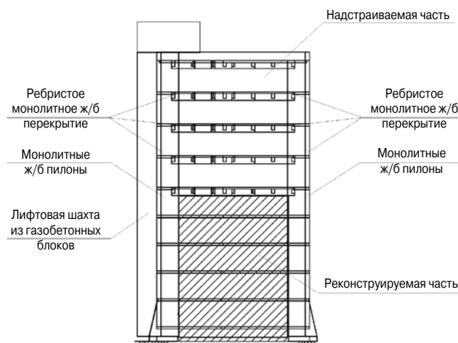
Рис. 5. Конструктивная схема реконструируемого дома Fig. 5. Designed scheme of the reconstructed house
