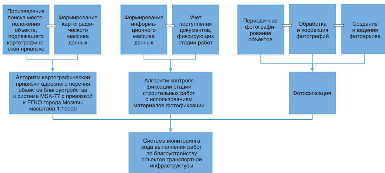
Рис. 1. Процесс построения системы мониторинга хода выполнения работ по благоустройству объектов транспортной инфраструктуры
