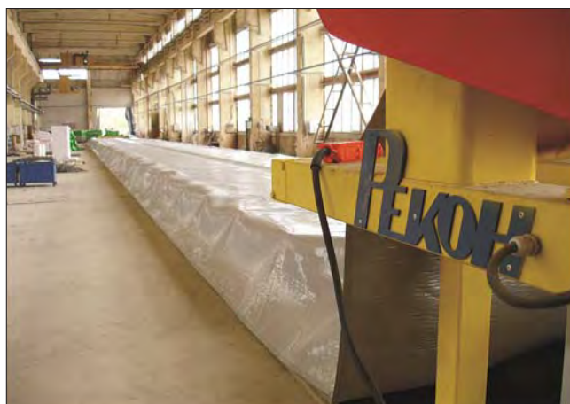
Изготовление на универсальном стенде ЗАО «Рекон» внутренних стен и преднапряженной плиты перекрытия для строительства 18–25-этажных жилых зданий. ГК «ПИК-Индустрия». 2019. г. Обнинск, Калужская обл.
