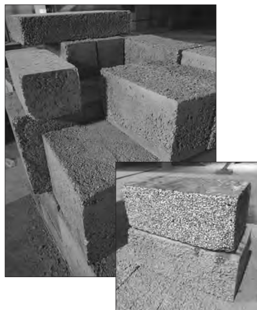
Рис. 4. Пенополистиролбетонные блоки, изготовленные в условиях цеха
