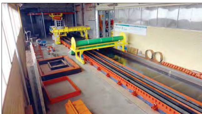
Мини-ДСК мощностью 15–20 тыс. м 2 общей площади каркаса зданий в год в составе БСУ, адресная подача, вибробетоноукладчик, универсальный стенд с сердечниками со встроенными магнитами, размотчик чехла с термопокрывалом. ЗАО «Рекон», г. Чебоксары. Срок исполнения 1,5 мес
