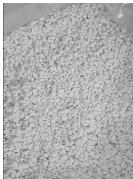
Рис. 3. Пенополистирольная крошка, полученная в механической дробилке
