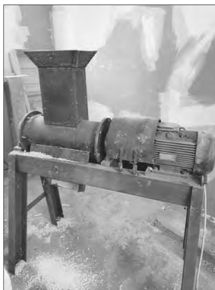
Рис. 2. Механическая дробилка, изготовленная в ремонтно-механическом цехе
