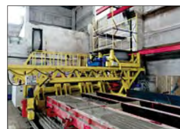
Строительство жилых домов с применением сборно-монолитного каркаса с пустотным настилом и трехслойной несущей стеной, изготовленными на универсальных стендах ЗАО «Рекон». Сейсмостойчивость 9 баллов. 2020 г. Магадан. СК «Заря» (Москва)
