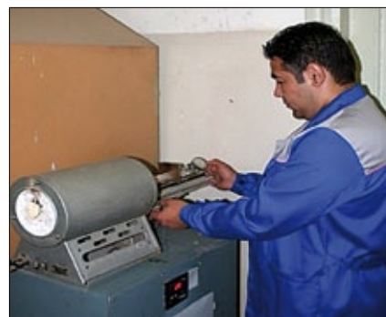
Ш. Самитов, аппаратчик, проводит дилатометрические исследования глинистого сырья
