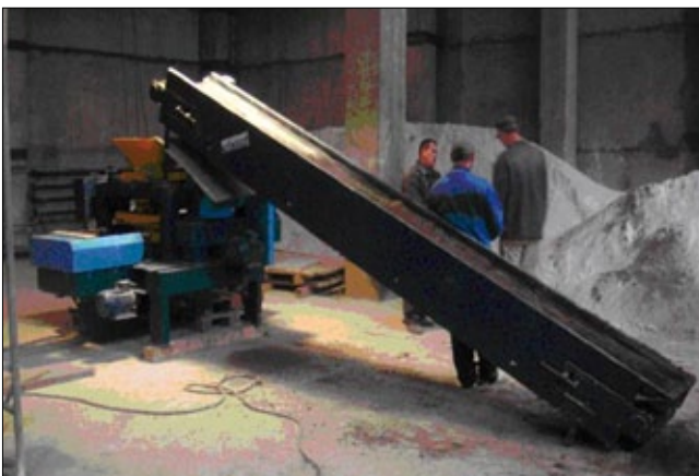
Рис. 4. Установка РК-250 для прессования стеновых и перегородочных блоков на основе фосфогипса и шлакового вяжущего
