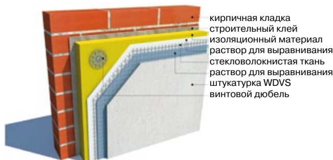
Схема расположения слоев в ССТИ. Фото Wacker Chemie AG
