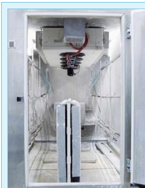
Технический центр WACKER. Материалы, модифицированные дисперсионными полимерными порошками VINNAPAS®, испытываются в климатической камере при различной влажности в пределах температур от -20 до +70°C (фото Wacker Chemie AG).
