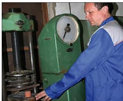
С. Семенов, инженер, проводит физико-механические испытания керамических образцов
