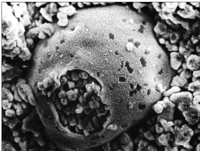
Рис. 3. Разрушение оболочки крупной частицы золы за счет пуццолановой реакции. Цементно-золевый камень, твердение 7 сут в нормальных условиях. РЭМ, увеличение ×6000
