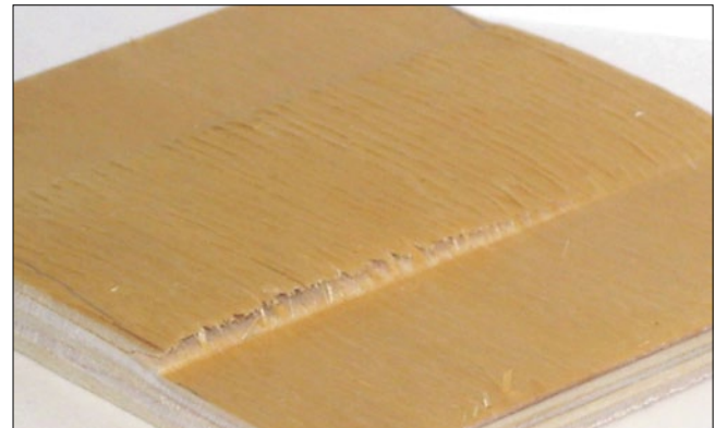
Рис. 2. Разрыв лицевого листа шпона, склеенного в разнотолщинной пресс-форме
