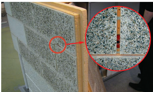
Для монтажа теплофасадных панелей «ЭКО-ЩИТ» в конструкцию вмонтированы пластиковые дюбели, которые обеспечивают крепление с помощью саморезов из оцинкованной стали
