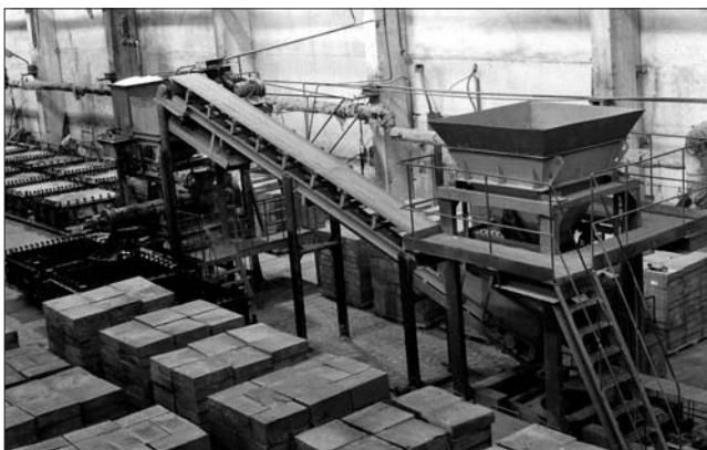
Цех по производству пенобетонных стеновых блоков (г. Тверь)
