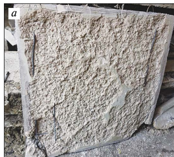
Рис. 8. Характерные виды обогреваемой поверхности образцов после испытаний: а – из обычного бетона; б – из обычного бетона с добавкой полипропиленовой микрофибры
