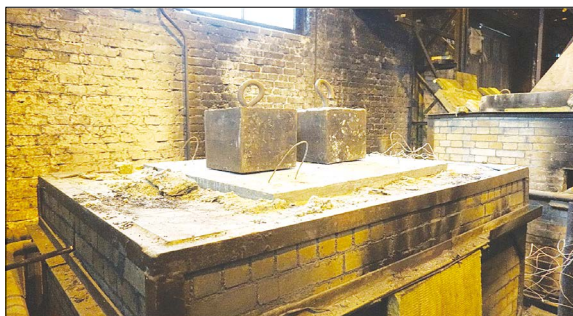
Рис. 7. Вид экспериментальной огневой установки с загрузкой малогабаритной плиты перекрытия
