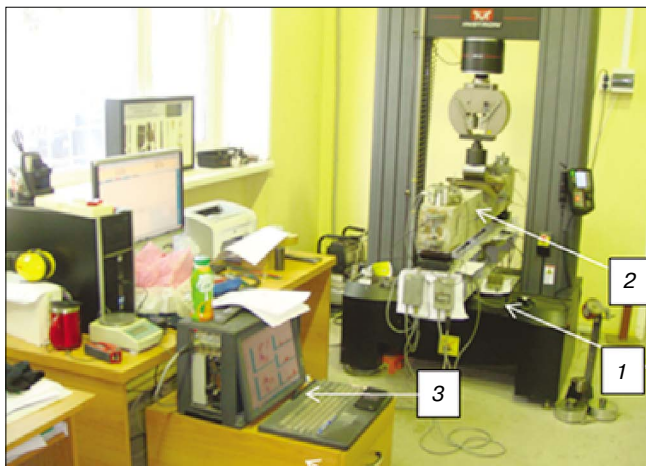
Рис. 1. Испытание балки. На рисунке показано нагружающее устройство (1), железобетонная балка (2), акустико-эмиссионная система A-Line 32D (3)
