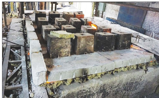
Рис. 4. Огневая установка с двумя крупногабаритными плитами перекрытий в процессе огневых испытаний
