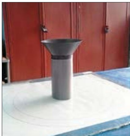
Рис. 1. Прибор для определения предельного напряжения сдвига самоуплотняющихся бетонных смесей
