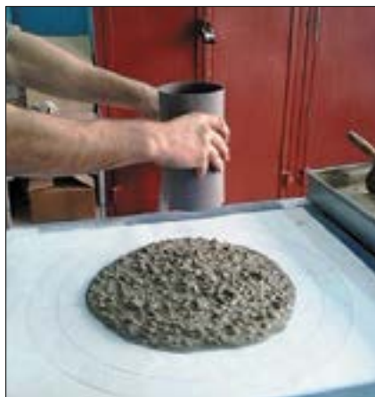
Рис. 1. Прибор для определения предельного напряжения сдвига самоуплотняющихся бетонных смесей
