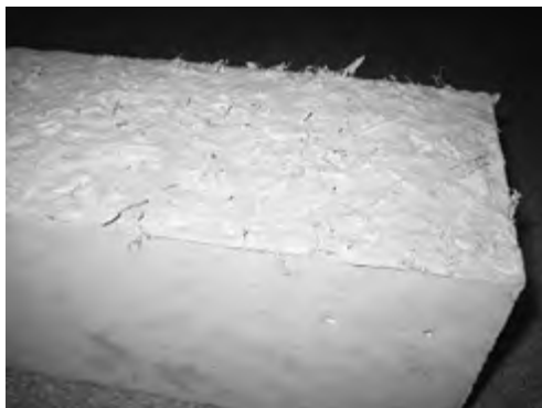
Рис. 6. Образец дисперсно-армированного микро-волокном бетона
