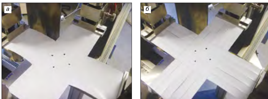
Рис. 2. Испытания технической ткани с покрытием при двухосном растяжении – два варианта исполнения образцов материала: а – без надрезов, б – с надрезами (рис. из [6])
