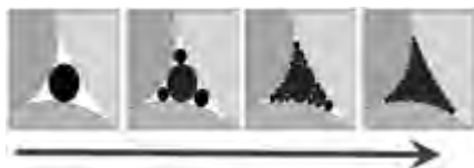
Рис. 1. Схема размещения мелких частиц между крупными при прессовании
