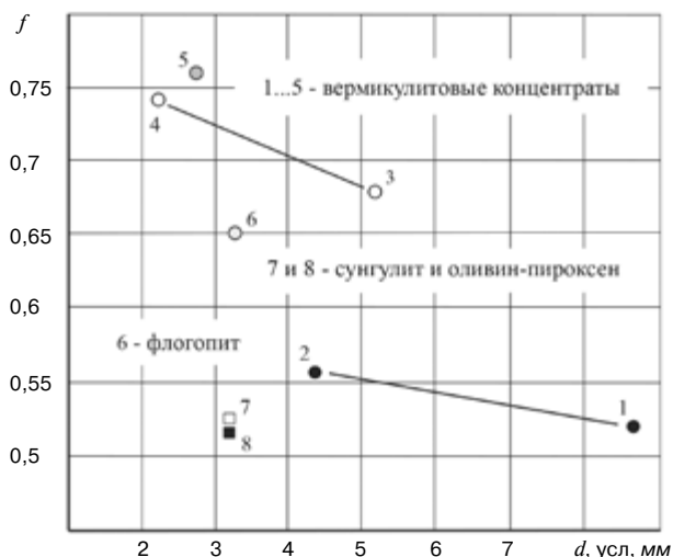
Рис. 5. Поле значений коэффициентов трения скольжения в движении сырьевых материалов, развернутых по условным диаметрам
