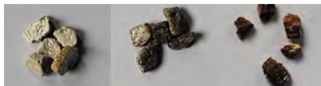
Рис. 4. Вспученные зерна вермикулита Ковдорского (слева), Кокшаровского и Татарского (справа) месторождений
