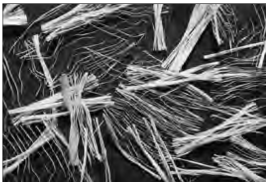
Рис. 1. Фибриллированные микроволокна, собранные в пучки
