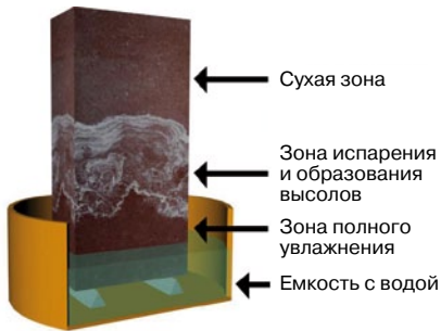
Рис. 3. Схема постановки вибропрессованных бетонных блоков в режиме капиллярного подсоса в течение трех месяцев
