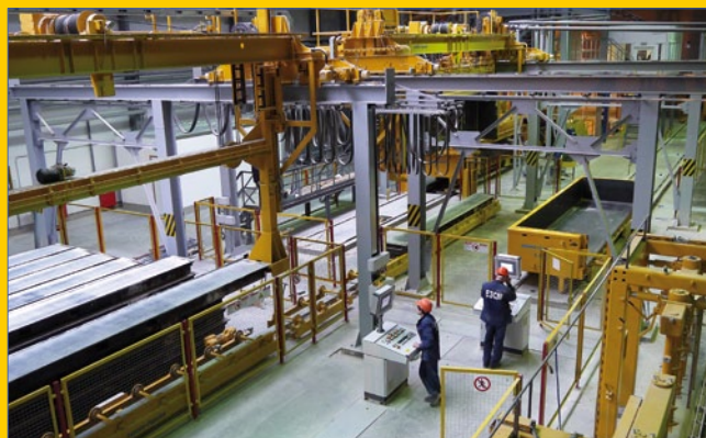
На Егорьевском заводе строительных материалов установлено современное оборудование MASA GmbH по производству автоклавного газобетона
