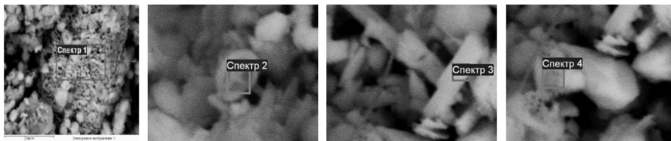
Рис. 3. РЭМ изображение трепела Ново-Айбесиновского месторождения. Элементные составы из рентгеновских спектров участков, %: «Спектр 1»: С – 12,5; О – 65; Al – 0,6; Si – 3,4; Ca – 18,1; Fe – 0,4 «Спектр 2» С – 25; О – 46,7; Al – 1,7; Si – 15,6; Ca – 9,7; Fe – 1,3; «Спектр 3»: О – 68; Al – 3,5; Si – 22,8; Ca – 5,7; «Спектр 4»: С – 20,9; О – 54; Al – 1, Si – 19,2; Ca – 4,9
