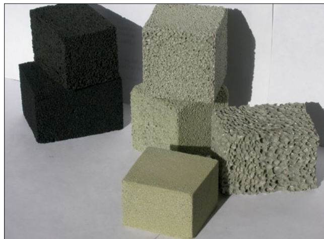
Образцы пеностекла с карбидом кремния и антрацитом
