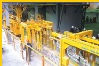
На Егорьевском заводе строительных материалов установлено современное оборудование MASA GmbH по производству автоклавного газобетона
