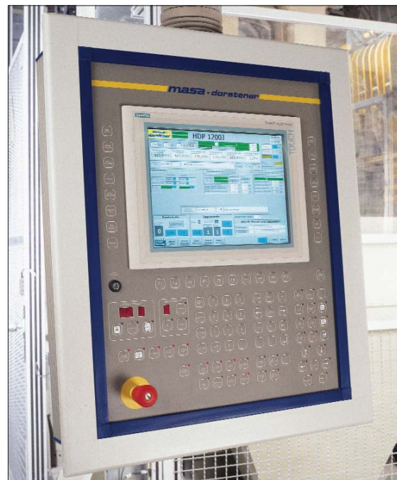
Рис. 3. Обслуживание пресса осуществляется посредством многофункциональной панели управления, на которой наглядно отображаются все важные параметры процесса уплотнения изделий. Смена формата может быть осуществлена в короткие сроки посредством вызова из памяти предварительно сохраненных параметров, относящихся к определенному типу продукции. Путем несложной операции можно переключить систему визуализации на язык страны эксплуатации, например на русский
