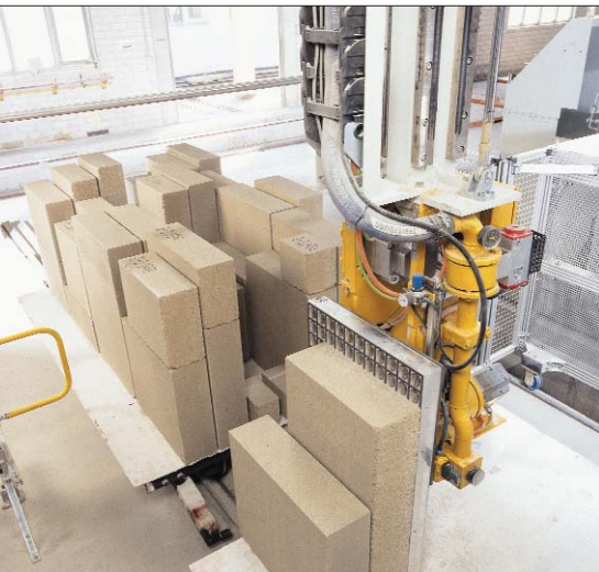
Рис. 5. Автомат-компоновщик после линии резки устанавливает фигурные элементы на запарочную тележку. Посредством сегментно-управляемой вакуумной пластины грейфера возможна аккуратная компоновка изделий различных форматов
