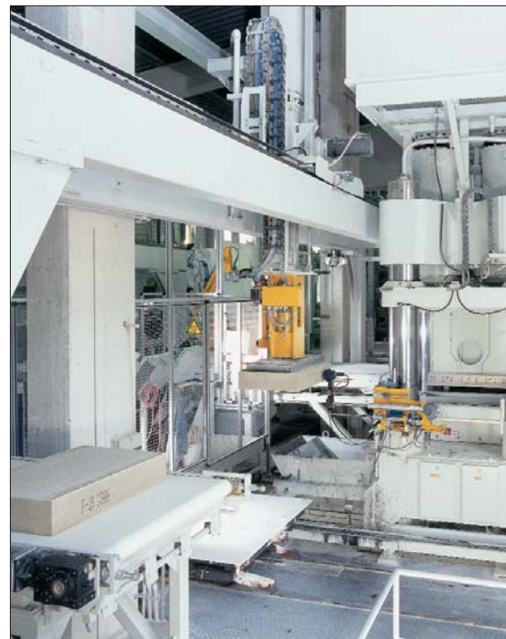
Рис. 4. Пресс Dorsa 2000 с двумя линиями резки для производства фигурных элементов. После прессования автоматическое приемное устройство снимает «сырое» силикатное изделие и переставляет его на транспортер подачи к линии резки, чтобы на выходе получить желаемый формат элемента
