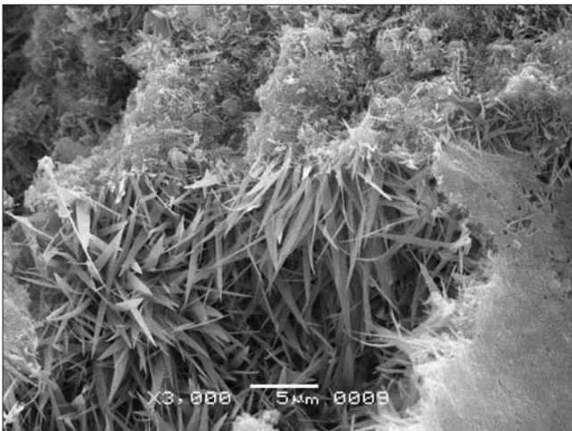
Рис. 2. Микроструктура силикатных образцов: а – известково-песчаные; б – с содержанием нанодисперсного сырья
