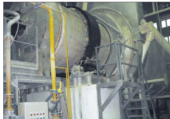
Новая печь обжига гипсового камня установлена на Волгоградском гипсовом заводе в 2007 г.
