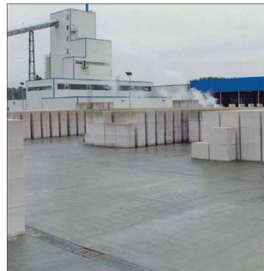
Рис. 10. Склад силикатной продукции на фоне смесительной башни. Изделия сортируются по форматам и распределяются по соответствующим зонам для хранения до погрузки
