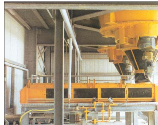
Рис. 9. Наряду со смесителем интенсивного действия для получения гомогенной силикатной массы особенно важно внедрение второй смесительной установки после реактора гашения извести. В данной установке повторного смешивания непосредственно перед подачей массы в пресс с дальнейшим дозированием воды задается точная влажность прессования. Установка последующего смешивания состоит из устройства разгрузки реактора с целевой подачей материала в двухвальный смеситель
