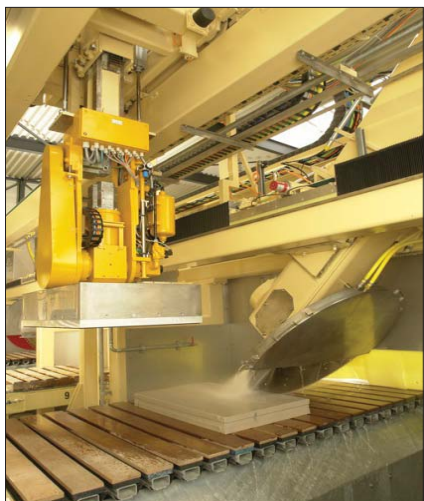
Рис. 7. На линии последующей резки возможно осуществление наклонных резов. Автоматическое устройство съема изделий оснащено вакуумной пластиной, позволяющей поднимать изделия различного формата. Продукция затем упаковывается на деревянных поддонах в соответствии с планируемым способом транспортировки
