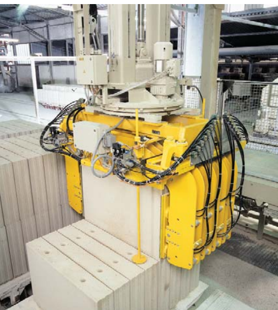
Рис. 2. Загрузка запарочных тележек автомат-укладчиком осуществляется в соответствии с заданными параметрами системы управления пресса. Основным критерием является оптимальное использование автоклавов. Захватные пластины приспособлены для работы с различными видами продукции от мелкоштучных изделий до крупноформатных элементов
