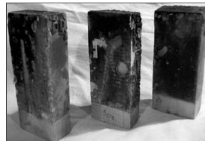
Рис. 2. Внешний вид образцов после испытания на огнестойкость
