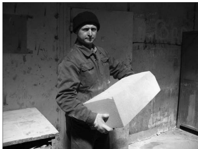
Рис. 2. Стеновой блок из материала КОНТУР
