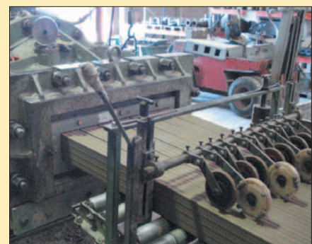
Семь потоков экструдированного бруса поступают в многострунный резчик, который...
