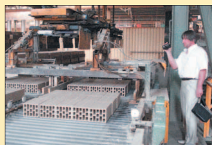
Первый зам. ген. директора ОАО «Спецремстройтрест» В.В. Сирота наблюдает за садкой кирпича на печные вагонетки
