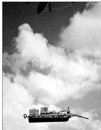
Рис. 2. Земснаряд ЗДЭК 400/20 на внешней подвеске к вертолету МИ-26
