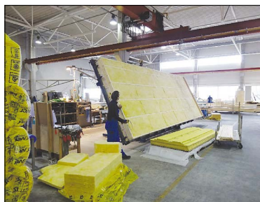
Рис. 7. Производство деревянных элементов стен на фабрике Fig. 7. Production of wooden elements in factory elements in factory
