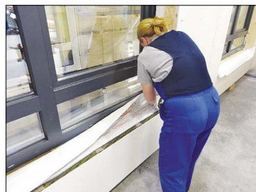
Рис. 8. Установка окон в стенные элементы на фабрике Fig. 8. Windows were installed into wall elements in factory
