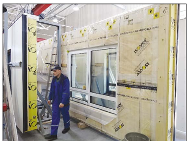
Рис. 8. Установка окон в стенные элементы на фабрике Fig. 8. Windows were installed into wall elements in factory
