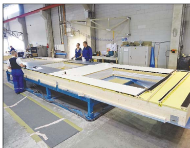
Рис. 7. Производство деревянных элементов стен на фабрике Fig. 7. Production of wooden elements in factory elements in factory
