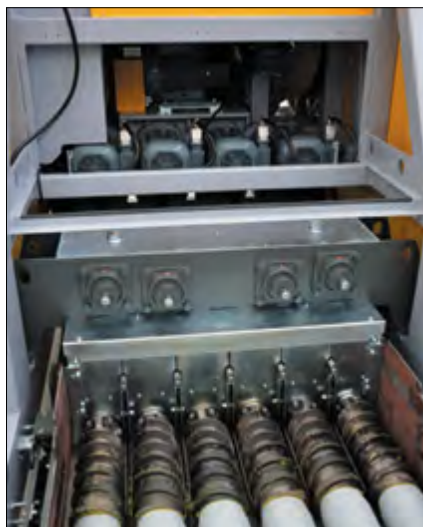
Экструдированная часть с независимыми моторами привода внешних шнеков
