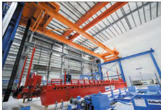
Сверхсовременная потолочная переворотная рама для поддонов Vario TURN для производства двойных стеновых панелей
