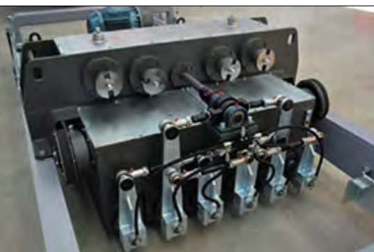
Трансмиссия закрытая в масляной ванне
