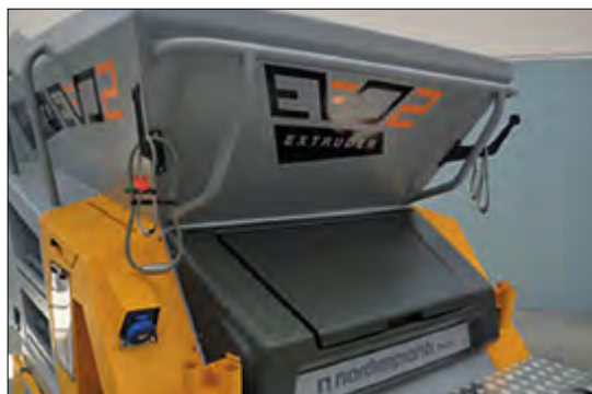
Хранение подъемных петель на консолях, установленных на бункере приема бетона
