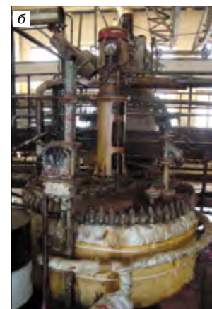
Рис. 1. Оборудование для размол исходного сырья и получения серосодержащего пропиточного состава: а – шаровая мельница; б – химический реактор с мешалкой
