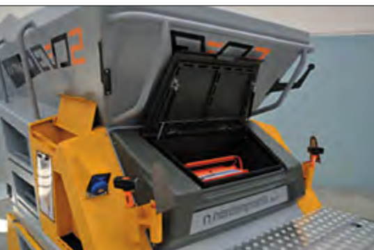
Полезные держатели инструментов, установленные на бункере приема бетона
