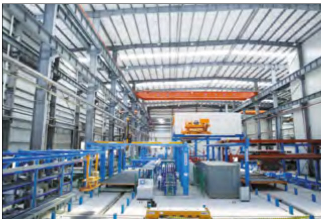
Shanghai Baoye увеличивает в 2015 г. с помощью новой линии производства сборных ЖБИ производственные мощности стеновых панелей и плит перекрытий до 800 тыс. м 2
