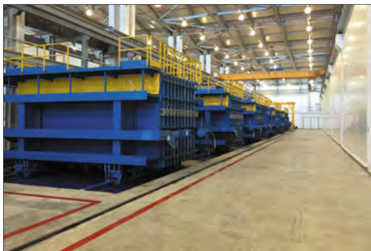
18 кассетных форм позволяют производить массивные стены и перекрытия на очень небольшой площади
