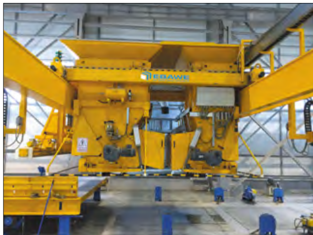
Бетонораздатчики для эффективной подачи свежего бетона укомплектованы двумя бункерами. Второй бункер меньшего объема предназначен для цветного или легкого бетона, который может наноситься на сборные железобетонные элементы в качестве фасадного слоя
