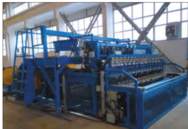
Для производства стандартных арматурных сеток на каждый из трех модернизированных заводов было поставлено по одной установке для сварки арматурной сетки типа Versity. Для производства скоб, хомутов и прутьев было установлено еще девять машин
