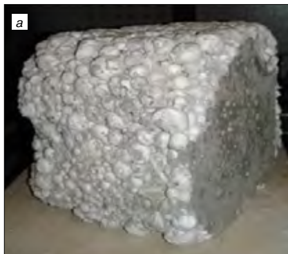
Рис. 1. Вид образцов пенополистиролбетона: а – построечного изготовления; б – в виде панели, выпускаемых по кассетной технологии (ППСБ-панели)
