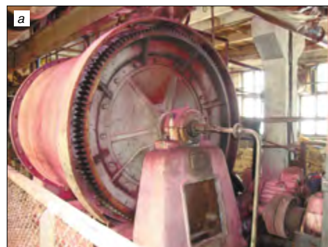
Рис. 1. Оборудование для размол исходного сырья и получения серосодержащего пропиточного состава: а – шаровая мельница; б – химический реактор с мешалкой
