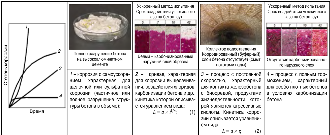
Рис. 2. Разновидности кинетики коррозии цементного камня [2, 3]
