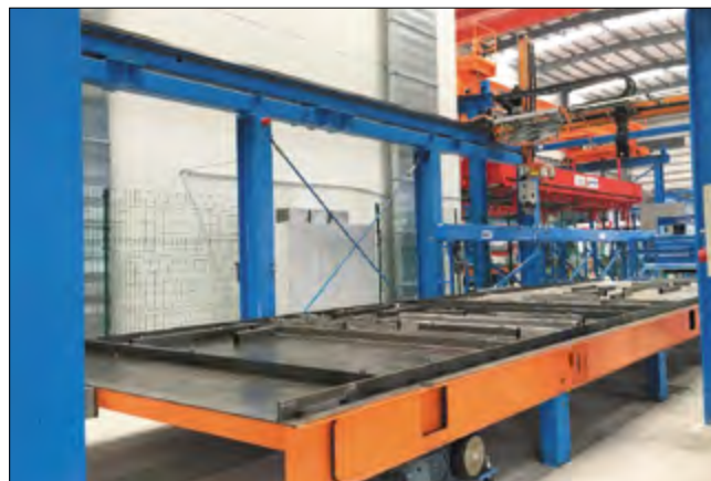
Опалубочный робот SMART SET устанавливает автоматически под управлением CAD/CAM опалубочные профили на подготовленные поддоны
