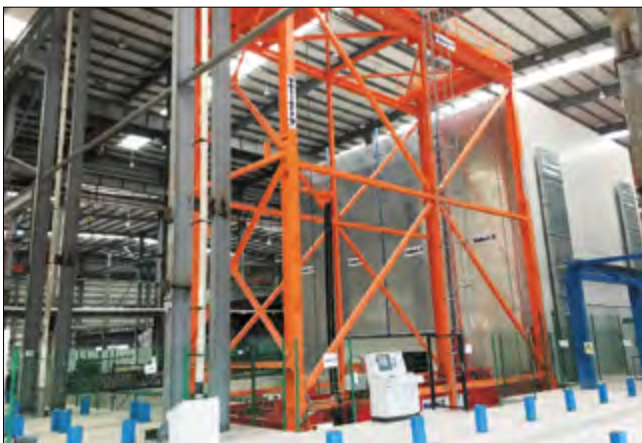
Теплоизоляционные и обогреваемые паром стеллажные башни камеры сушки управляются устройством для обслуживания стеллажей
