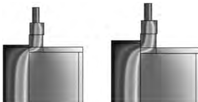
Рис. 3. Распределение температуры в сечении подоконного фрагмента трехслойной стеновой конструкции с учетом нахлеста утеплителя на раму
