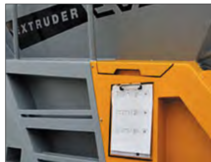
Клипборд А4 для производственных заданий, установленных на бункере приема бетона
