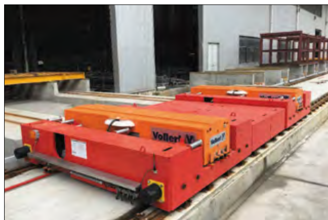
Подъемно-транспортная платформа SMART LOGISTIC соединяет пост разгрузки со складом за пределами цеха
