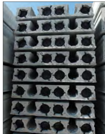
Первые пустотные плиты высотой 200 мм, произведенные на экструдере EVO2
