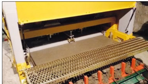
Экструдер evo150 series для производства пустотных плит 1500 мм шириной
