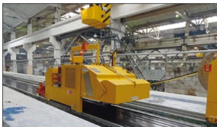
Машина для чистки, смазки производственных стенов и раскладки арматуры, работающая на сжиженном газе
