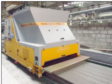
Экструдер – уникальное решение для производства облегченных пустотных плит с наилучшими техническими характеристиками
