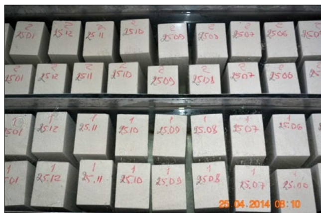
Рис. 1. Выдерживание образцов в воде и солевом растворе
