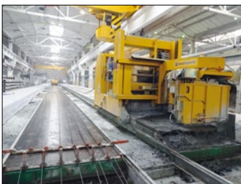
Машина для распиловки готовых изделий под различными углами
