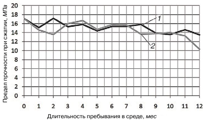
Рис. 2. Зависимость прочности образцов от времени пребывания: 1 – после выдерживания в артезианской воде; 2 – после выдерживания в солевом растворе
