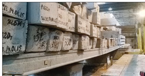
Испытание несущей способности на заводе ЖБИ-1 в Тюмени
