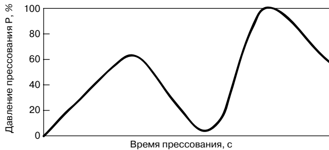
Рис. 5. Общий вид диаграммы двухстадийной прессовой нагрузки
