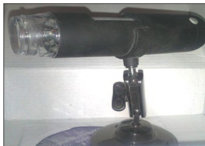
Рис. 1. Цифровой микроскоп с 200-кратным увеличением
