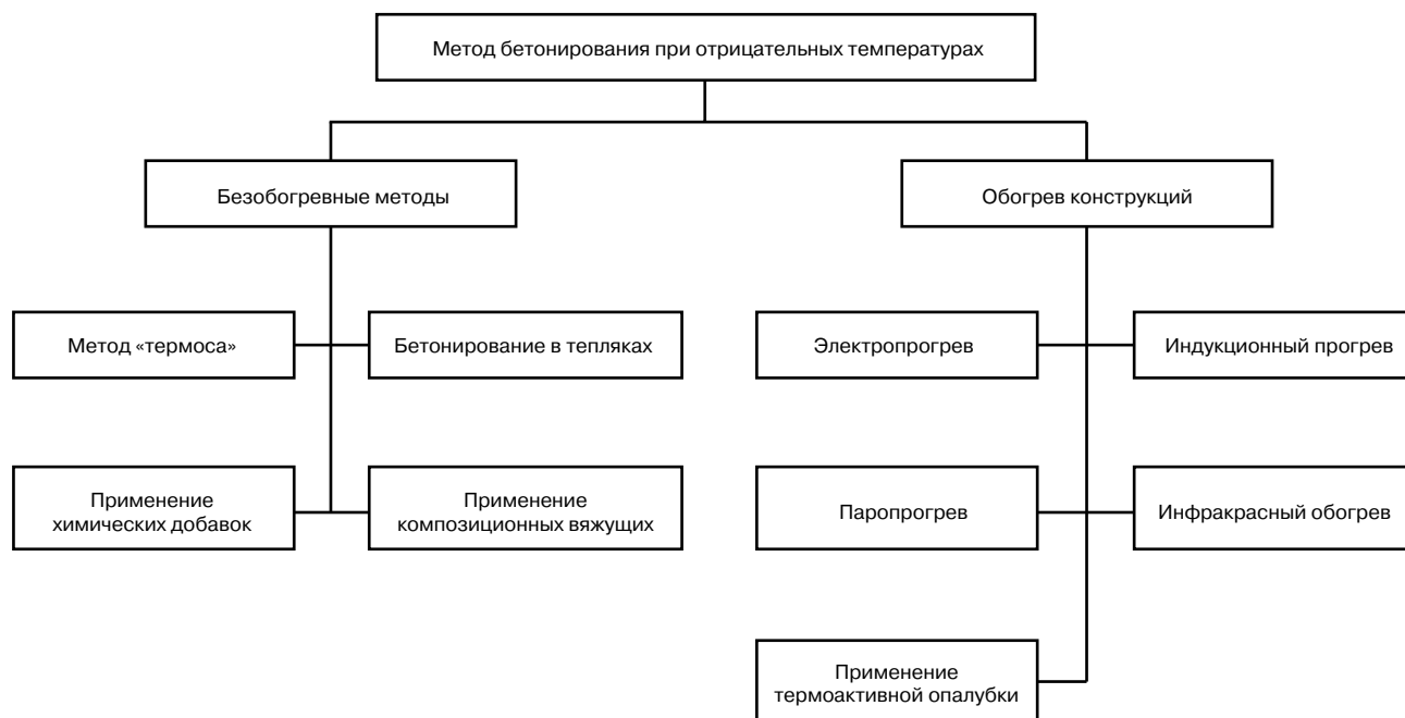
Рис. 1. Способы бетонирования при отрицательной температуре [3]
