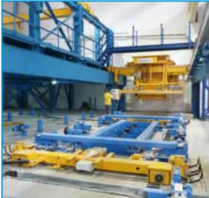
Ввод в эксплуатацию бетонораздатчика на ЗАО «Клинский проектно-строительный комбинат» (Московская обл.)
