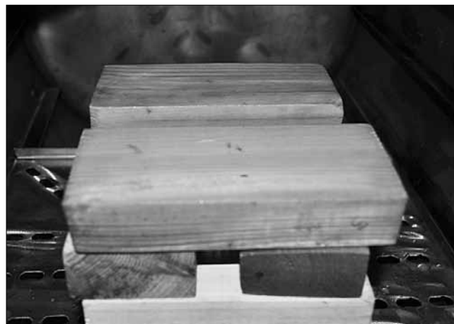
Рис. 5. Образец древесины после обработки минеральным модификатором
