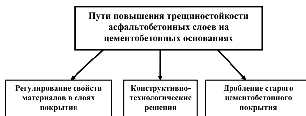
Рис. 4. Пути повышения трещиностойкости асфальтобетонных слоев
