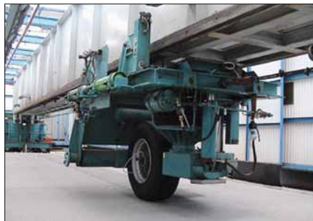
Рис. 1. Установка ускоренного испытания LINTRACK, Дания
