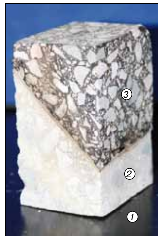
Рис. 3. Образец-призма для испытания на сдвигу стойкость системы бетон — гидроизоляция — литой асфальтобетон: 1 — асфальт; 2 — гидроизолятор; 3 — вибролитой асфальтобетон
