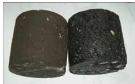
Образцы асфальтобетона (слева – с пылью системы газоочистки; справа – стандартный состав)
