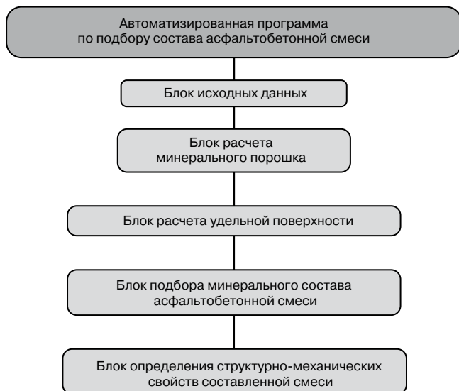
Рис. 1. Общая структура алгоритма автоматизированного проектирования состава асфальтобетонной смеси
