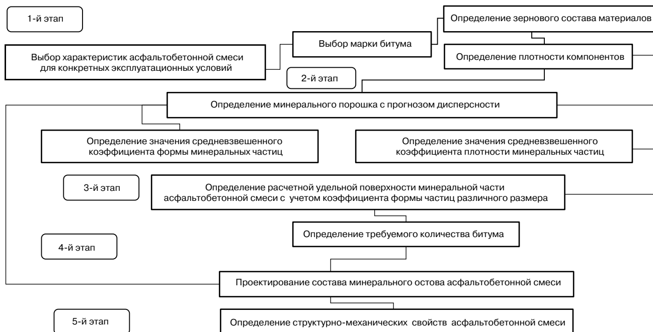
Рис. 8. Алгоритм работы программы автоматизированного проектирования состава асфальтобетона
