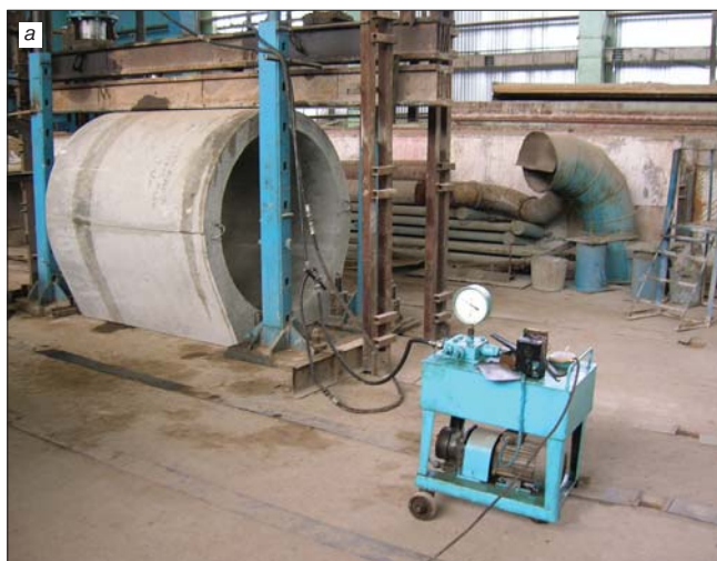
Рис. 5. Испытания конструкций для дорожного строительства на стенде БашНИИстроля: а – звено водопропускной трубы с плоским опиранием и отверстием 1,5 м, б – трехшарнирная арка пролетом 6 м
