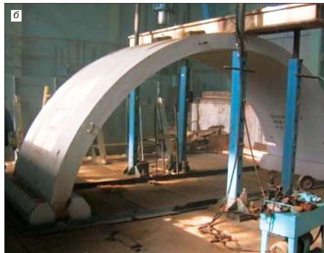
Рис. 5. Испытания конструкций для дорожного строительства на стенде БашНИИстроля: а – звено водопропускной трубы с плоским опиранием и отверстием 1,5 м, б – трехшарнирная арка пролетом 6 м
