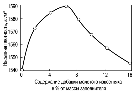
Рис. 3. Зависимость насыпной плотности зернисто-дисперсной системы от содержания дисперсной части
