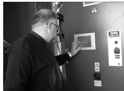
Программа испытаний задается на пульте с сенсорным управлением и отражает параметры (давление, влажность и др.)
