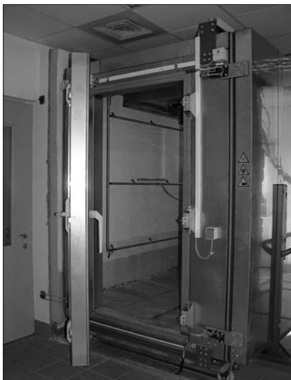
Климатическая камера герметично присоединяется к стене, на которой смонтирована теплоизоляционная система
