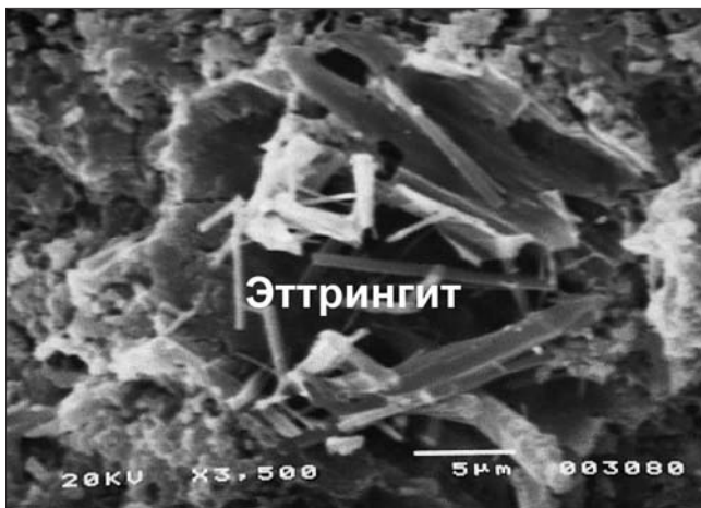
Рис. 4. Вторичный этtringит в затвердевшем цементном камне после 10 циклов попеременного увлажнения – высушивания
