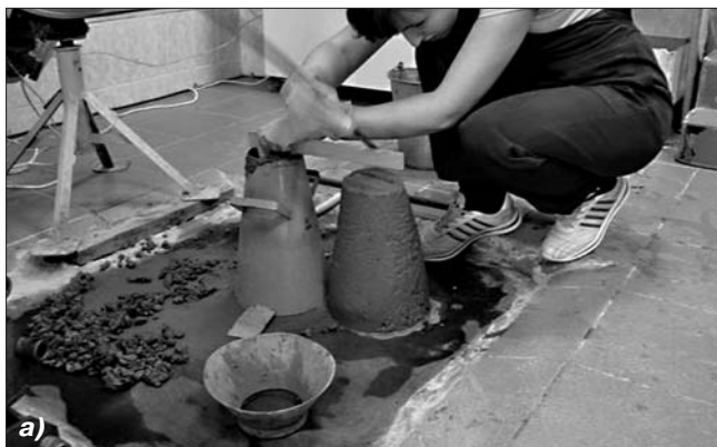
Лабораторные испытания бетонной смеси: а) без применения суперпластификатора С-3; б) с применением суперпластификатора С-3
