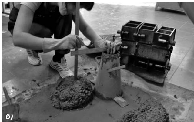
Лабораторные испытания бетонной смеси: а) без применения суперпластификатора С-3; б) с применением суперпластификатора С-3
