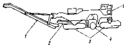
Рис. 1. Общий вид машины с фрезерным рабочим органом 1 — разгрузочный конвейер; 2 — приемный конвейер; 3 — гусеничный ход; 4 — фрезерный рабочий орган; 5 — хвостовая машинистка
