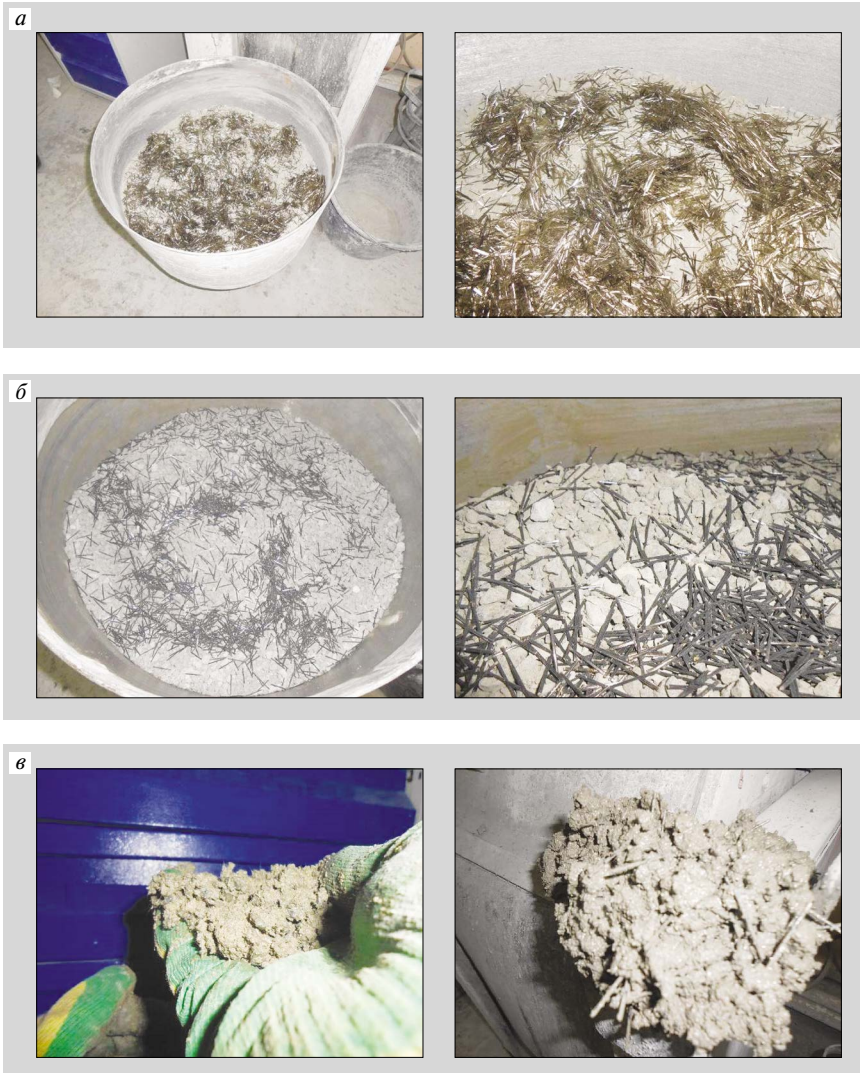
Рис. 1. Этапы введения фибры в бетонную смесь и характер ее распределения: а – состав 1 с тонким базальтовым волокном (микрофиброй); б – состав 2 с базальтокомпозитной фиброй (макрофиброй); в – фибробетон, состав 1 и 2 после перемешивания
