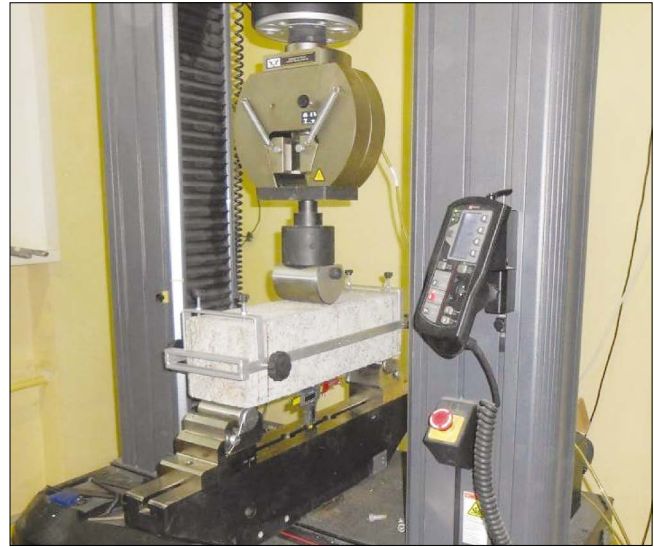
Рис. 3. Схема испытания образцов-призм из ФБ по EN 14651
