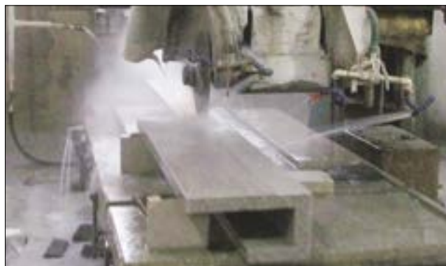
Рис. 4. Доработка поверхности гранитных изделий на фрезерном станке приводит к возникновению зоны техногенной нарушенности и снижению прочностных свойств камня
