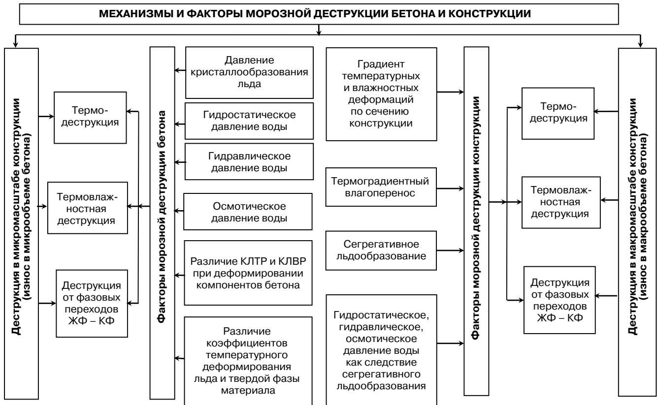
Рис. 1. Механизмы и факторы деструкции бетона и конструкции в условиях морозного воздействия эксплуатационной среды
