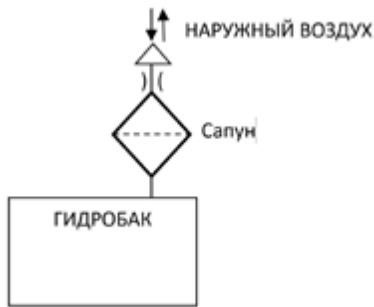
Рис. 1. Гидробак с сапуном (воздушным фильтром) с тонкостью фильтрации 2–3 мкм
