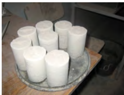
Рис. 1. Образцы силикатного бетона на отходах металлургии до и после автоклавной обработки
