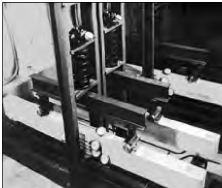
Рис. 1. Пружинные установки для длительного испытания армированных ячеисто-бетонных балок размерами 10×16×180 см
