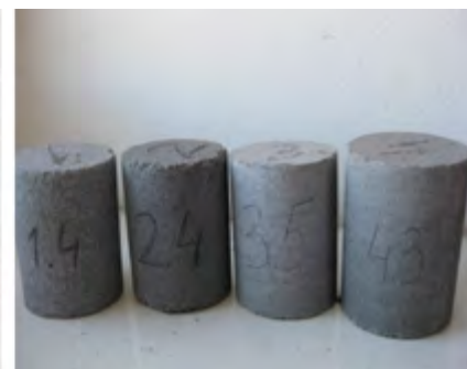
Рис. 1. Образцы силикатного бетона на отходах металлургии до и после автоклавной обработки
