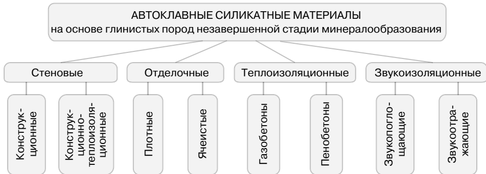
Рис. 2. Номенклатура силикатных материалов на основе использования глинистых пород незавершенной стадии минералообразования
