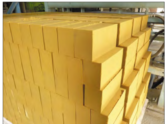
Рис. 3. Силикатный сырец с добавлением желтого пигмента
