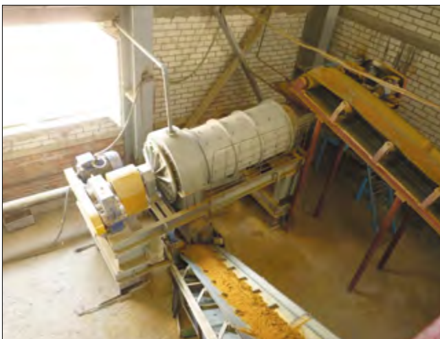
Рис. 2. Смеситель в линии подготовки силикатной массы на заводе ООО «Инвестиционная индустрия» (Тамбов)
