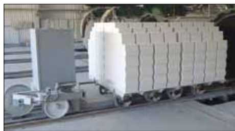
Рис. 8. Самоходная тележка передаточного моста готовой продукции обеспечивает выкатку вагонеток из автоклава и их погрузку на передаточный мост в автоматическом режиме
