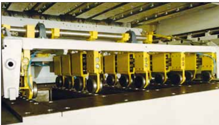
Рис. 6. Захваты для кирпича на гидравлических прессах серии VIKING выполнены по принципу «один кирпич – один захват с отдельным пневмоприводом». Это означает, что один захват рассчитан всегда на один кирпич, а не на группу, что позволяет максимально бережно перемещать силикатные изделия и при этом не травмировать их
