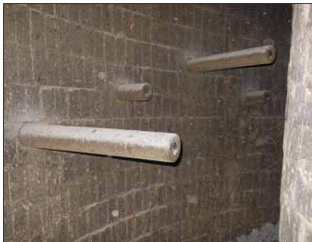
Рис. 6. Установка периферийных фурм внутри корпуса действующей кольцевой печи
