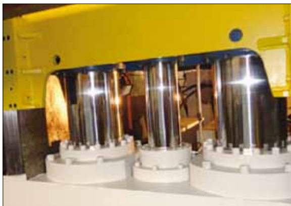
Рис. 5. Главные и вспомогательные гидравлические цилиндры изготовлены с использованием самых высококачественных уплотнений и направляющих ведущих мировых производителей, обеспечивающих надежное уплотнение и долгий срок службы
