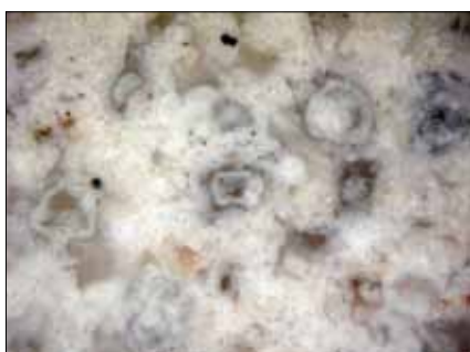
Рис. 7. Поверхность прессованного образца на границе с формой, увеличение ×500
