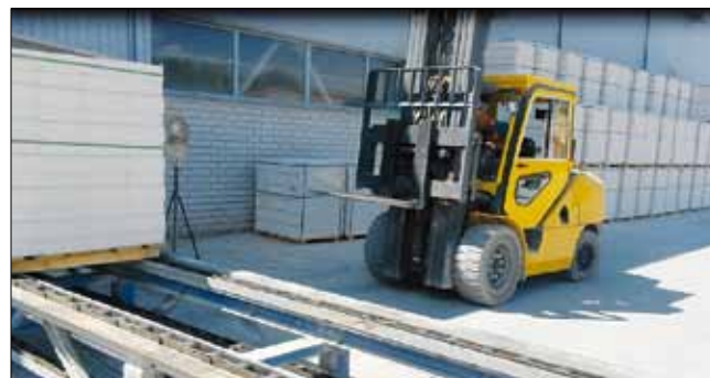
Рис. 11. Готовая продукция выдается на склад посредством цепного транспортера, с которого производится отгрузка заказчиком или складирование на площадку завода
