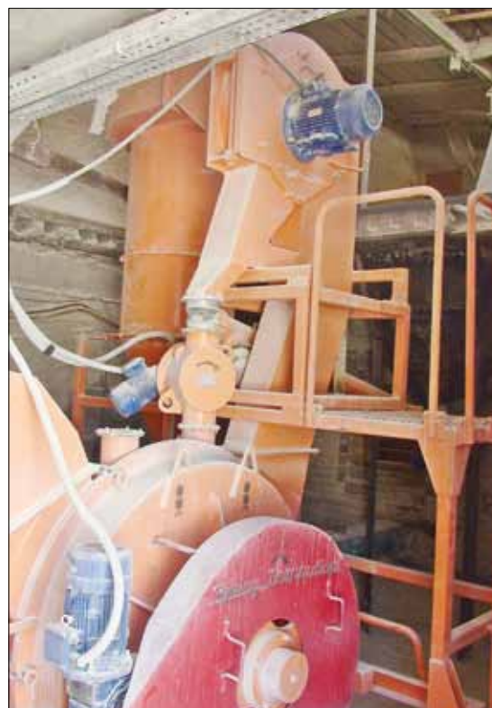
Рис. 3. Ударно-центробежная мельница «ТрибокINETИКА» на ЗАО «ККСМ», 2010 г. ввода в эксплуатацию
