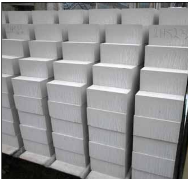
Рис. 2. Изменение внешнего вида белого кирпича после автоклавной обработки
