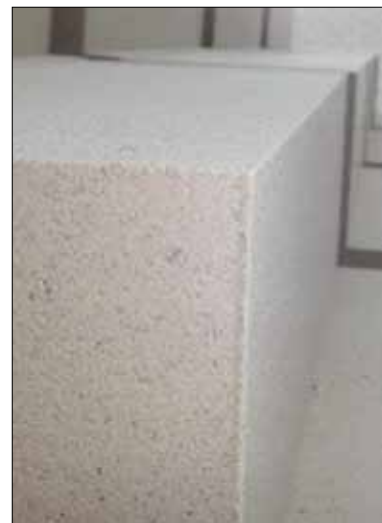
Рис. 3. Запатентованная система подвижной пресс-формы с гидравлическим управлением позволяет перед прессованием принудительно поднимать пресс-форму и исключить зазоры между контрштампом и пресс-формой. Благодаря этому изделия получаются с практически идеальными гранями. После прессования пресс-форма возвращается вниз, зазоры восстанавливаются и каретка с контрштампом легко, без сопротивления, а значит, и без лишнего износа и лишних потерь энергии перемещается из положения прессования в положение выталкивания изделий
