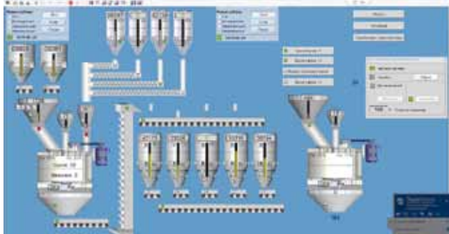
Рис. 10. На мониторе системы автоматизации отображается вся необходимая информация для контроля и управления процессами приготовления массы, прессования и перемещения электропередаточных мостов и вагонеток
