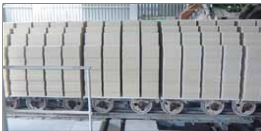
Рис. 7. Передаточный мост сырца в полностью автоматическом режиме производит откатку вагонеток от прессы и загружает в назначенный оператором автоклав
