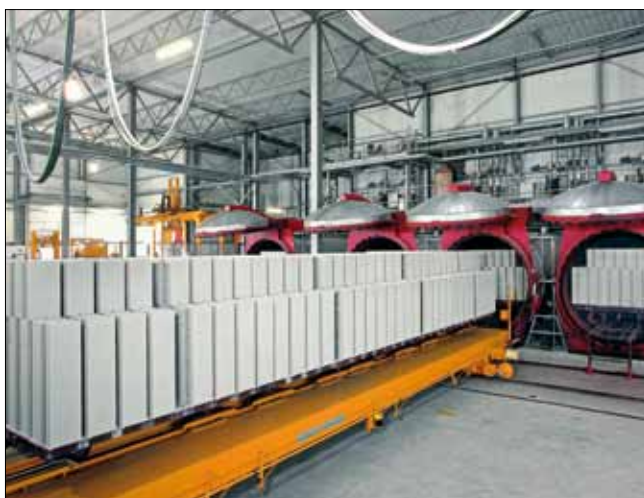
Рис. 8. Транспортер вместимостью до 8 запарочных тележек в пред-автоклавной зоне обеспечивает загрузку и выгрузку автоклавов. Данная концепция позволяет использовать тупиковые автоклавы
