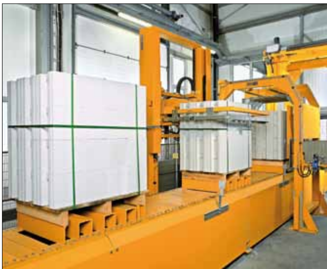
Рис. 11. Машины обвязки легко регулируются, что обеспечивает надежную упаковку изделий различных форматов. Еще на стадии проектирования завода были определены характеристики «конечного» транспортера и вид применяемых (деревянных) поддонов
