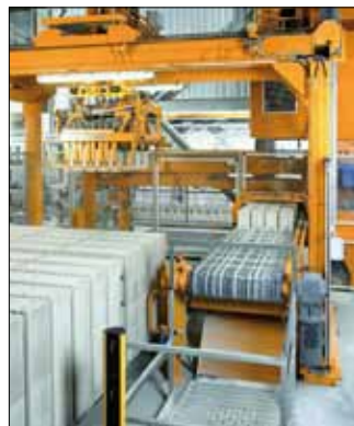
Рис. 7. Загрузка запарочных тележек автоматом-укладчиком происходит полностью автоматически в соответствии с заданными параметрами системы управления. Основным критерием является оптимальное использование автоклавов. Захватные пластины регулируются в соответствии с видом производимой продукции от мелкоштучных изделий до изделий среднего формата
