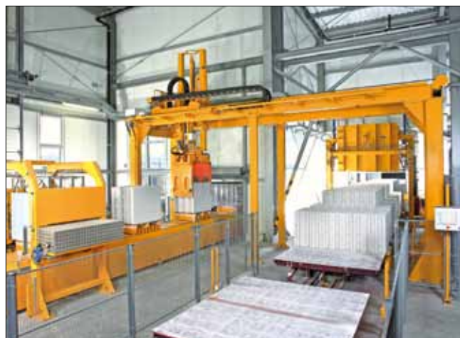
Рис. 9. Загруженная запарочная тележка автоматически устанавливается под грейфером разгрузки. Пустые тележки очищаются и подаются к прессам
