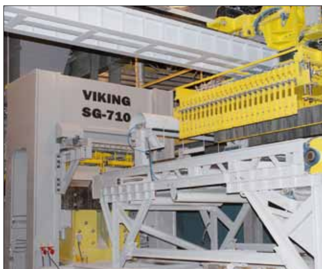
Рис. 1. Пресс VIKING SG-710 усилием 710 т для прессования силикатного кирпича
