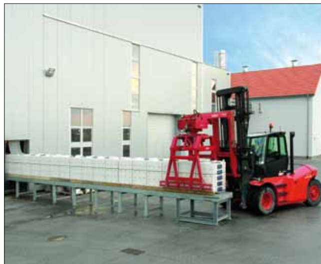
Рис. 12. Готовые пакеты изделий подаются к месту складирования при помощи вилочного погрузчика. Если пакеты изделия упаковываются без поддонов, то их можно транспортировать при помощи соответствующих захватов. Изделия сортируются по форматам в зоне складирования для дальнейшей отгрузки
