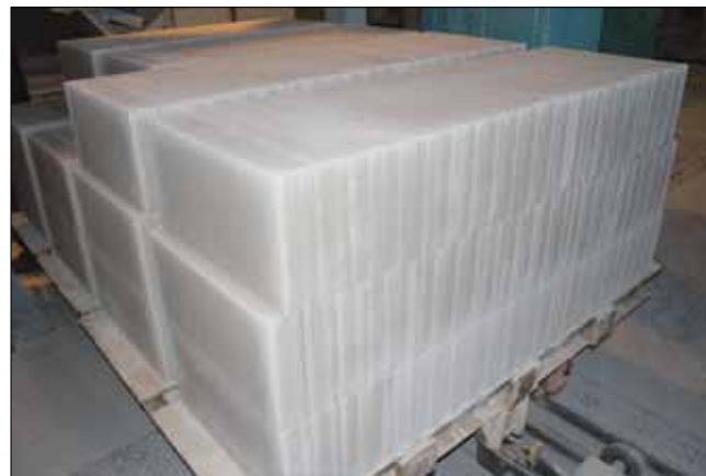
Рис. 3. Перегородочные силикатные блоки размером 500×250×70, изготовленные на прессе VIKING SG-710
