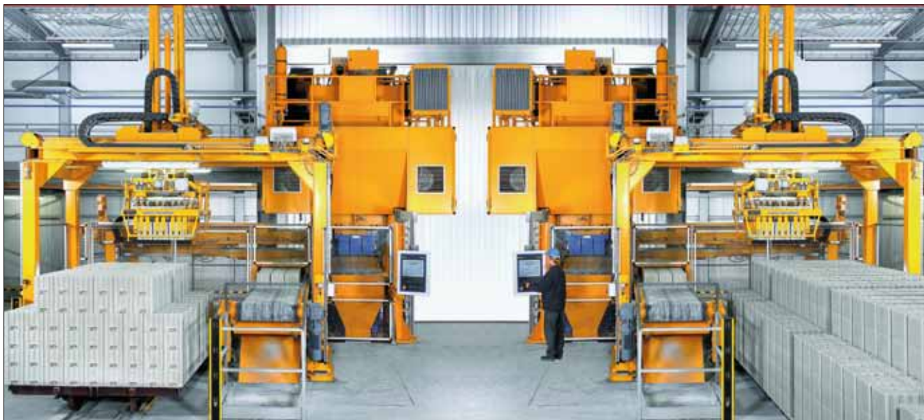
Рис. 2. Основа завода – два прессы DORSTENER HDP 800. В производстве блоки среднего формата 8DF размерами 250×240×248 мм. Благодаря простоте управления с обслуживанием обоих прессов справляется один оператор
