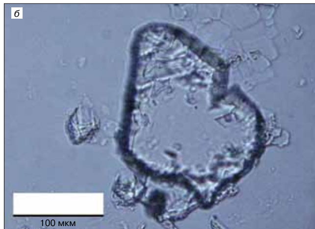
Рис. 2. Микрофотографии древесной муки в проходящем свете: а – исходной, б – модифицированной 0,35% кремнезолом
