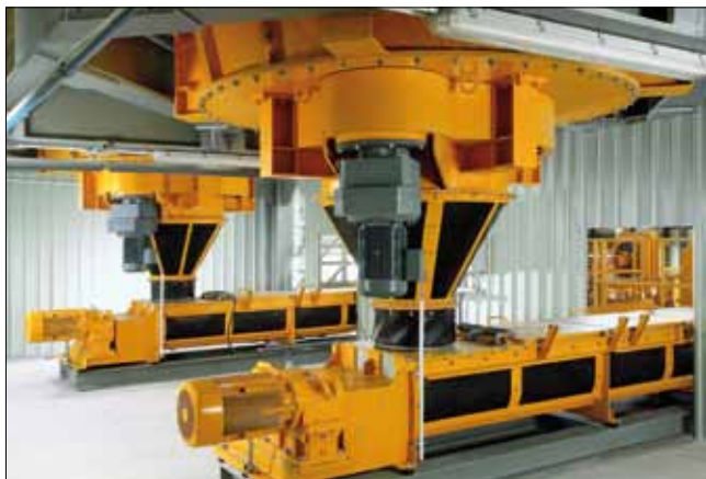
Рис. 6. Для обеспечения равномерного процесса гашения извести и достижения однородной массы сразу за реактором устанавливается вторая смесительная установка. В данной установке происходит процесс домешивания и доувлажнения смеси, в результате которого достигается точная влажность массы перед ее подачей в пресс. Установка последующего смешивания состоит из устройства разгрузки реактора и подачи материала в двухвальную смеситель
