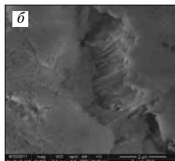
Рис. 2. Особенности микроструктуры цементного камня в возрасте 28 сут: а – трещины в микропоре контрольного ЦК, \times 40000 ; б – зарастающая трещина с новообразованиями ЦК с добавкой, \times 40000 ; в – морфология новообразований ЦК с добавкой на границе микропоры, \times 10000 ; г – морфология новообразований ЦК с добавкой внутри микропоры, \times 20000
