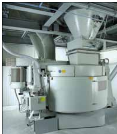
Рис. 5. Для обеспечения однородности массы в основном смесителе происходит процесс интенсивного перемешивания сырьевых материалов. После смешивания масса подается в соответствующие реакторы прессов, где происходит реакция гашения извести. Размеры реакторов соответствуют потребности прессов в силикатной массе
