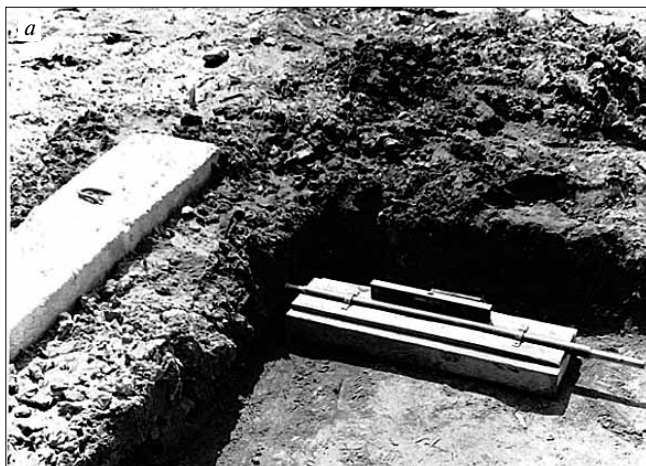
Рис. 2. Приспособление по изготовлению геопланта (а) и готовая геопланта конструкция (б) в основании модели ленточного фундамента
