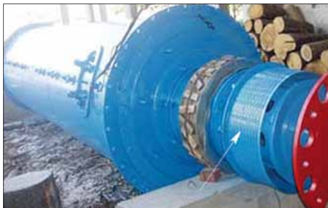
Рис. 2. Рабочий вид выходного узла мельницы
