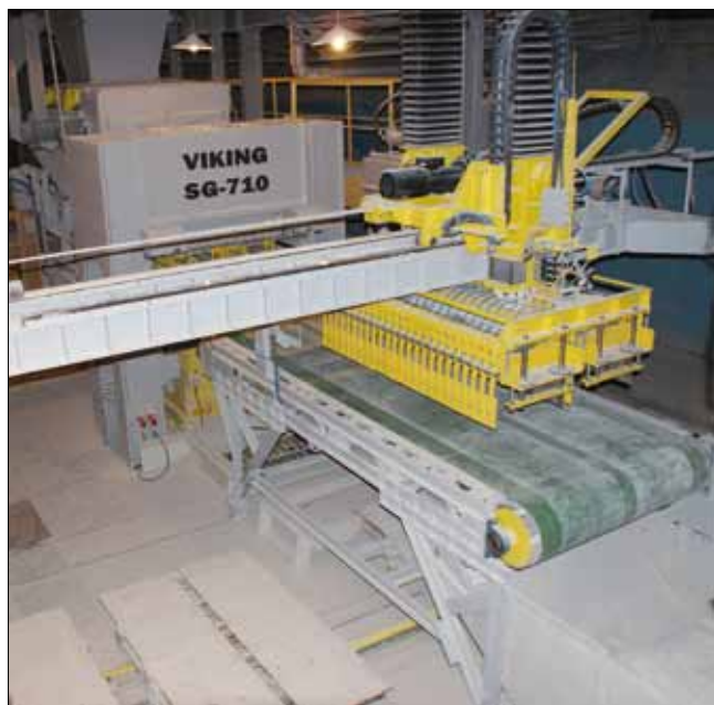
Рис. 2. Автомат-укладчик пресса VIKING SG-710
