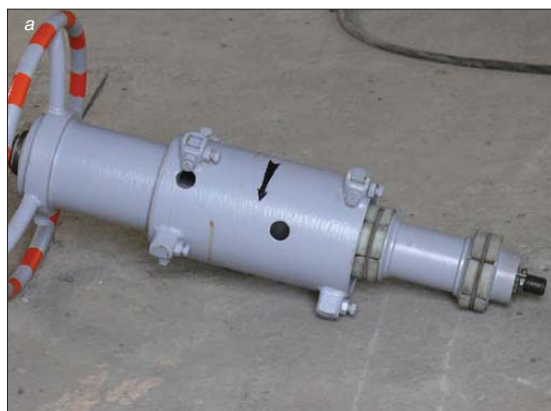
Рис. 4. Ручное приспособление для обточки хризотилцементных труб: а – общий вид; б – схема: 1 – винт; 2 – упор; 3 – сухарь с пружинным кольцом; 4 – распорка; 5 – корпус; 6 – резец для выполнения фаски (2 шт.); 7 – резец для обточки наружного диаметра (3 шт.); 8 – резец для обточки торца (2 шт.); 9 – направляющая; 10 – маховик
