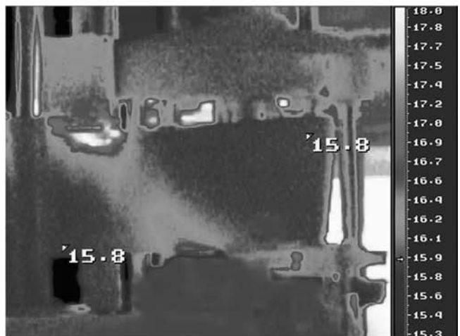
Тепловизионное изображение балки после циклического нагружения
