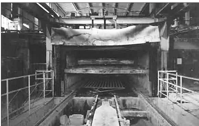
Рис. 2. Загрузка панели в пропарочную камеру
