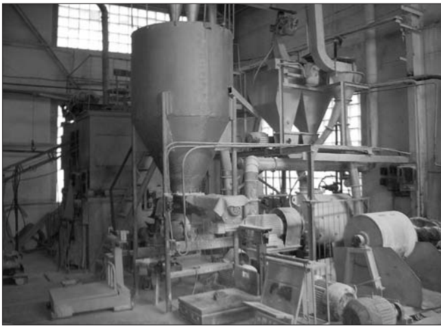
Установка по выпуску «Супергипса» на опытном заводе ВНИИСТРОМа (ОАО «Стройматериалы»)
