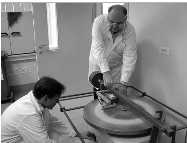
Круг Бёме позволяет проводить испытания бетонов на истираемость, которые являются определяющими для стяжек и наливных полов
