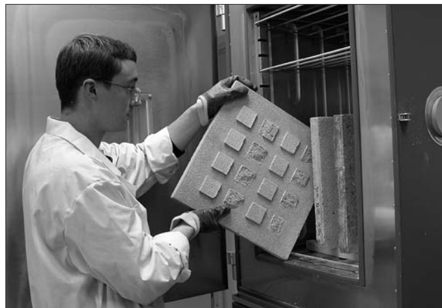
Камера испытания образцов на количество циклов замораживания-оттаивания необходима для тестирования любых составов для наружного применения
