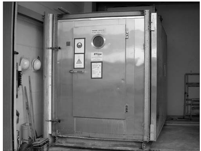
Скоро в техническом центре можно будет проводить климатические испытания материалов и конструкций на образцах площадью более 5 м 2
