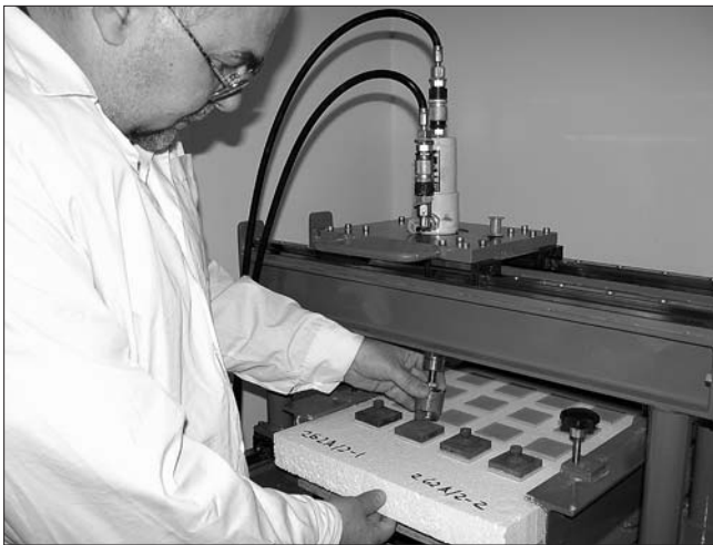
Испытания на отрывной машине позволяют определять эффективность клеевого состава
