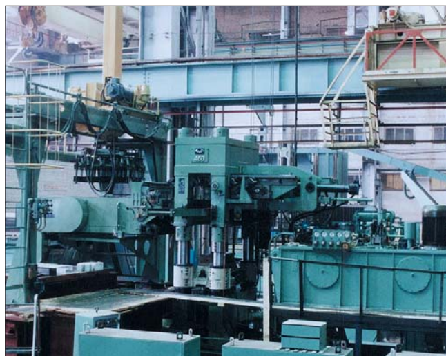
Автоматизированный комплекс АКД0537.01 для изготовления силикатного кирпича на базе гидравлического пресса усилием 4,6 МН
