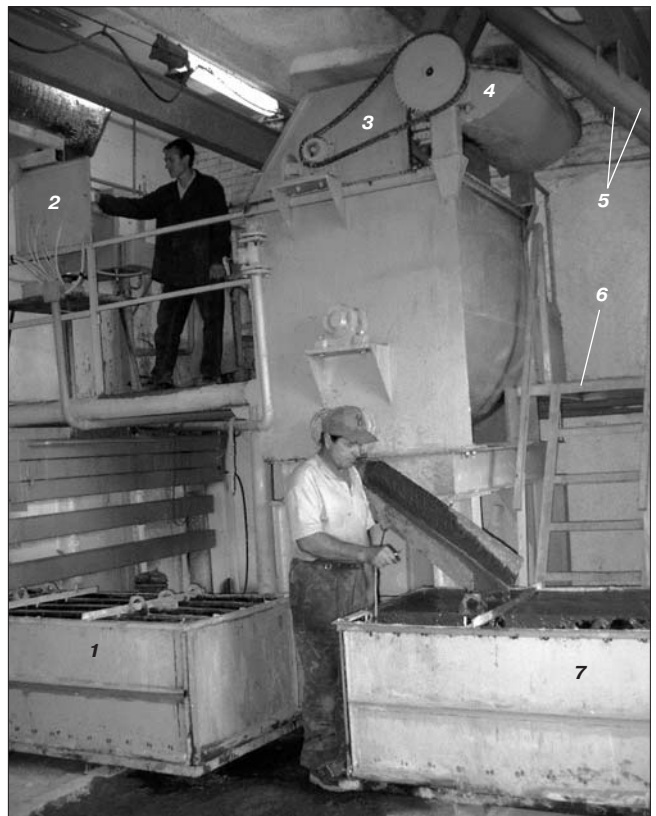
Рис. 3. Заливка пенобетона в формы: 1 – четырехсекционная форма; 2 – пеногенератор и пульт управления; 3 – пенобетоносмеситель; 4 – дозатор; 5 – шнеки; 6 – площадка обслуживания; 7 – трехсекционная форма под заливку
