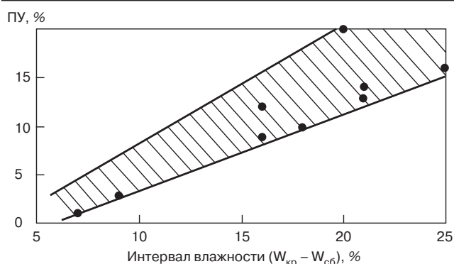
Рис. 2. Зависимость пылеуноса из печей от протяженности зоны пылеобразования
