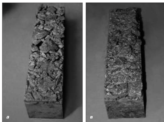
Рис. 2. Образцы-призмы дорожного основания, укрепленного СВПС: а – с добавкой С-3; б – с добавкой Melment F 10
