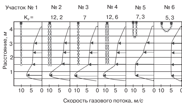
Рис. 3. Распределение газового потока по вертикальному сечению цепной завесы
