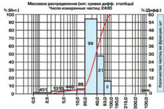
Рис. 3. Интегральная и дифференциальная кривые распределения частиц микрокальцита по размерам
