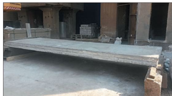
Рис. 7. Опытный образец плиты перекрытия на основе ЛСТК и пеногипса в натуральную величину (1,8×6 м, толщина 22 см)
