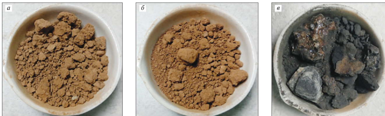
Рис. 1. Внешний вид исследуемого сырья: а – глина Бугурусланского месторождения; б – глина Новосергиевского месторождения; в – топливный шлак
