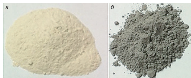
Рис. 2. Изменение цвета при помоле маршалита на пружинной мельнице: а – немолотый; б – молотый
