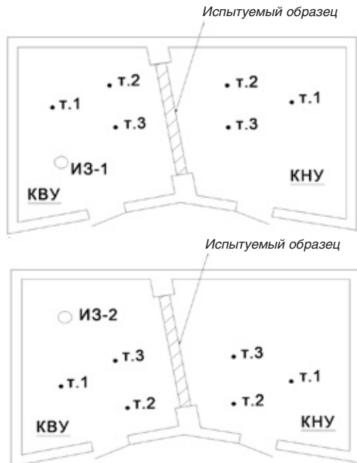
Рис. 3. Месторасположение испытуемого образца, источника звука, точек измерения
