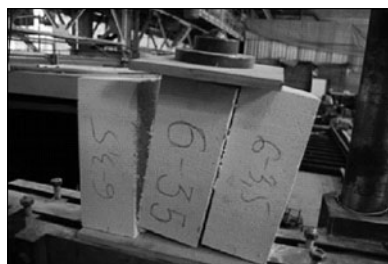
Рис. 2. Схема испытания, общий вид испытательной установки и испытанный образец при определении касательного сцепления в кладочном шве
