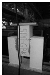
Рис. 2. Схема испытания, общий вид испытательной установки и испытанный образец при определении касательного сцепления в кладочном шве
