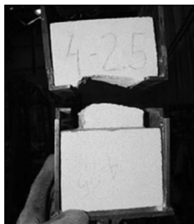
Рис. 1. Схема испытания, общий вид испытательной установки и испытанный образец при определении нормального сцепления в кладочном шве
