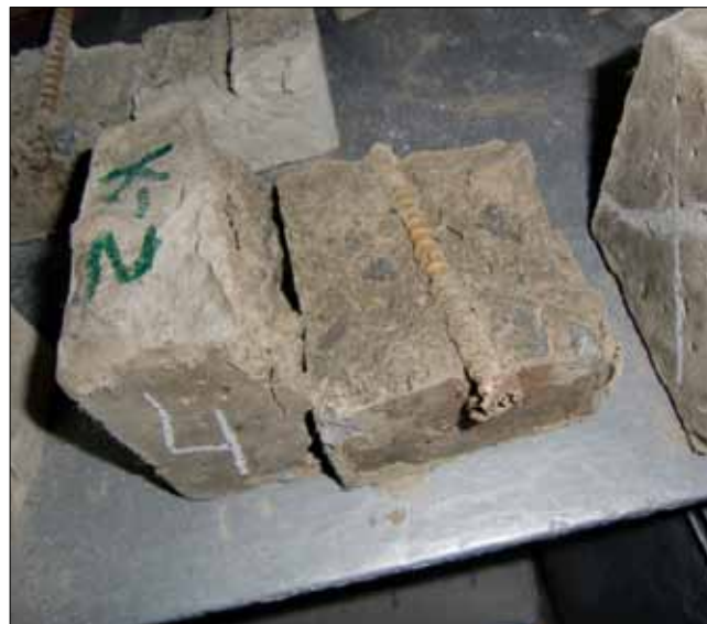
Рис. 2. Характер нарушения сцепления между фибробетоном и арматурой различной вещественной природы
