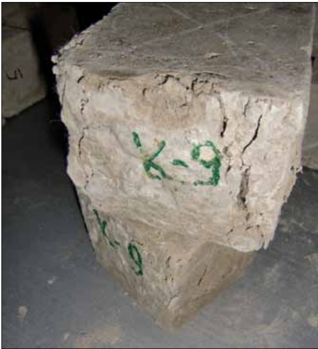
Рис. 1. Характер разрушения при сжатии бетона, дисперсно-армированного полиамидными волокнами длиной 12 мм в количестве 0,5% от массы цемента
