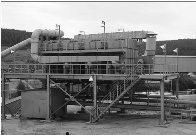
Рис. 1. Аспирационно-пылеулавливающая установка, расположенная на открытом воздухе
