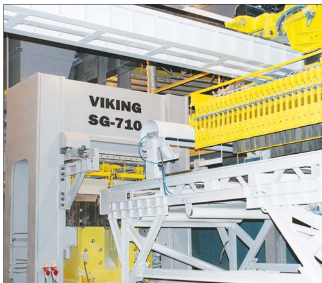
Гидравлический пресс VIKING SG-710, оборудованный комплектом технологической оснастки для прессования силикатных блоков размером 500×70×250 мм
