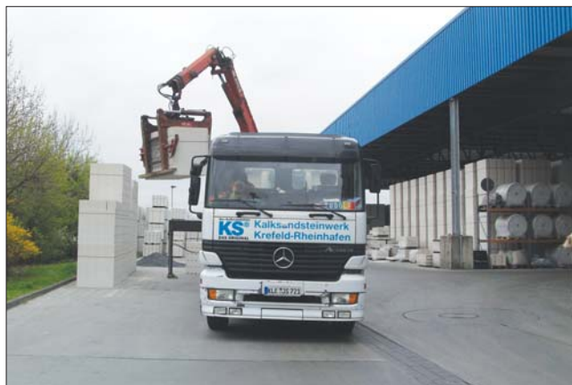
Высокую сохранность продукции при транспортировке обеспечивают фирменные машины, оснащенные краном со специальным захватом
