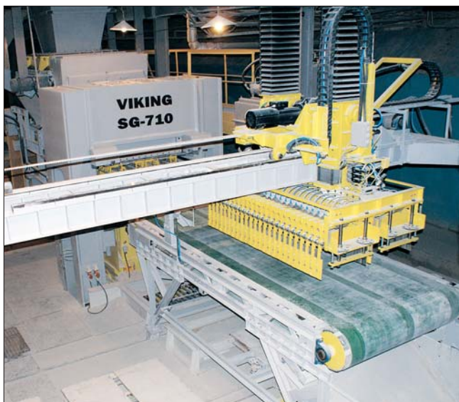
Гидравлический пресс VIKING SG-710, оборудованный комплектом технологической оснастки для прессования силикатных блоков размером 500×70×250 мм
