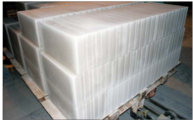
Силикатные блоки 500×70×250 мм на автоклавной вагонетке
