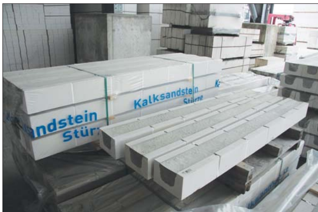
Армированные перемычки изготавливаются в специальном отделении обработки продукции
