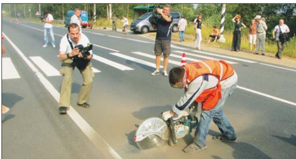
Специалист передвижной лаборатории МАДИ производит распил трассы для выемки керна
