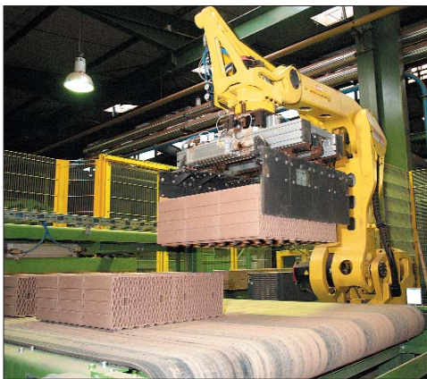
Роботизированная установка для укладки блоков
