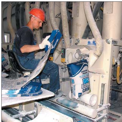
Затаривание сухих смесей осуществляется современными фасовочными машинами
