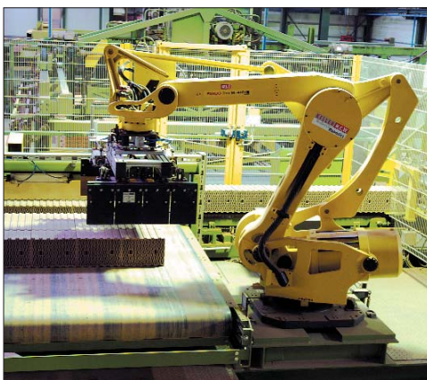
Укладка блоков высокоскоростными роботами
