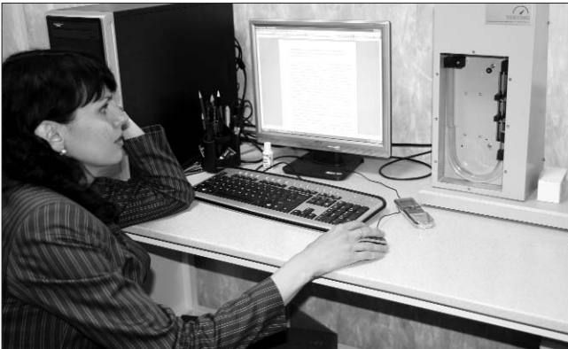
Рис. 5. Прибор Блэйна для определения удельной поверхности цемента
