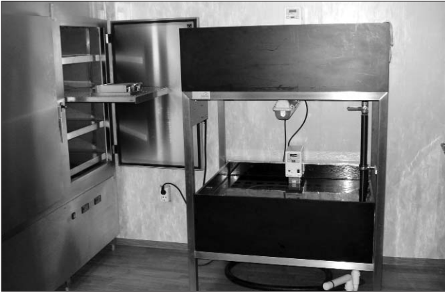
Рис. 3. Климатическая камера для выдержки образцов в первые сутки твердения и двухуровневая водяная баня для хранения образцов после распалубки
