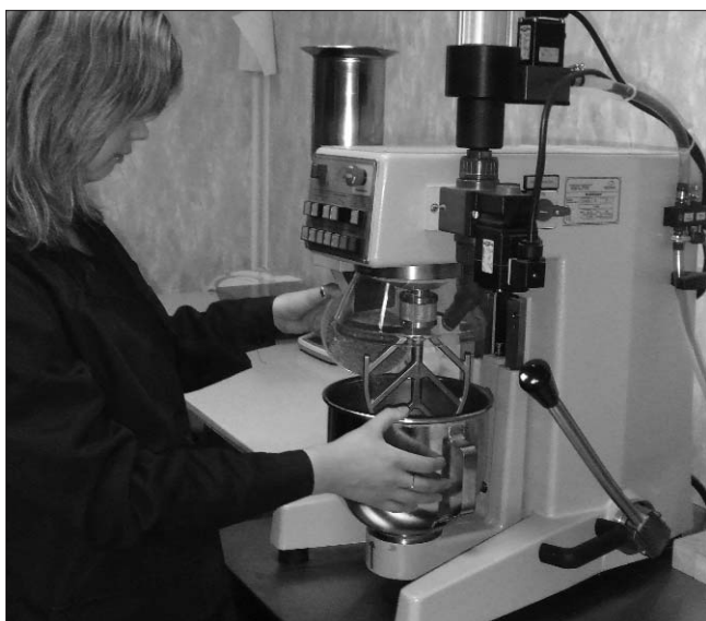
Рис. 1. Лабораторный растворосмеситель с электромеханическим устройством для подачи полифракционного песка и автоматической системой дозирования воды
