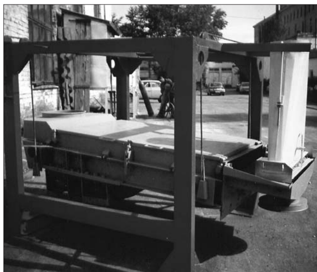
Рис. 2. Грохот инерционного типа – сортировка
