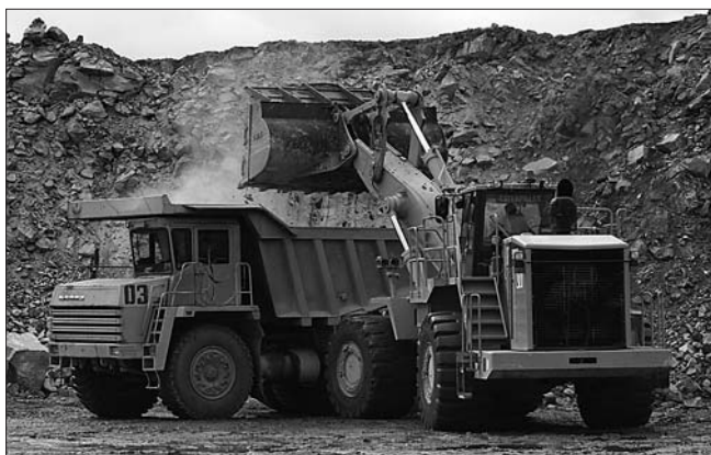
Работа фронтального погрузчика CAT 988G в забое карьера Ровное
